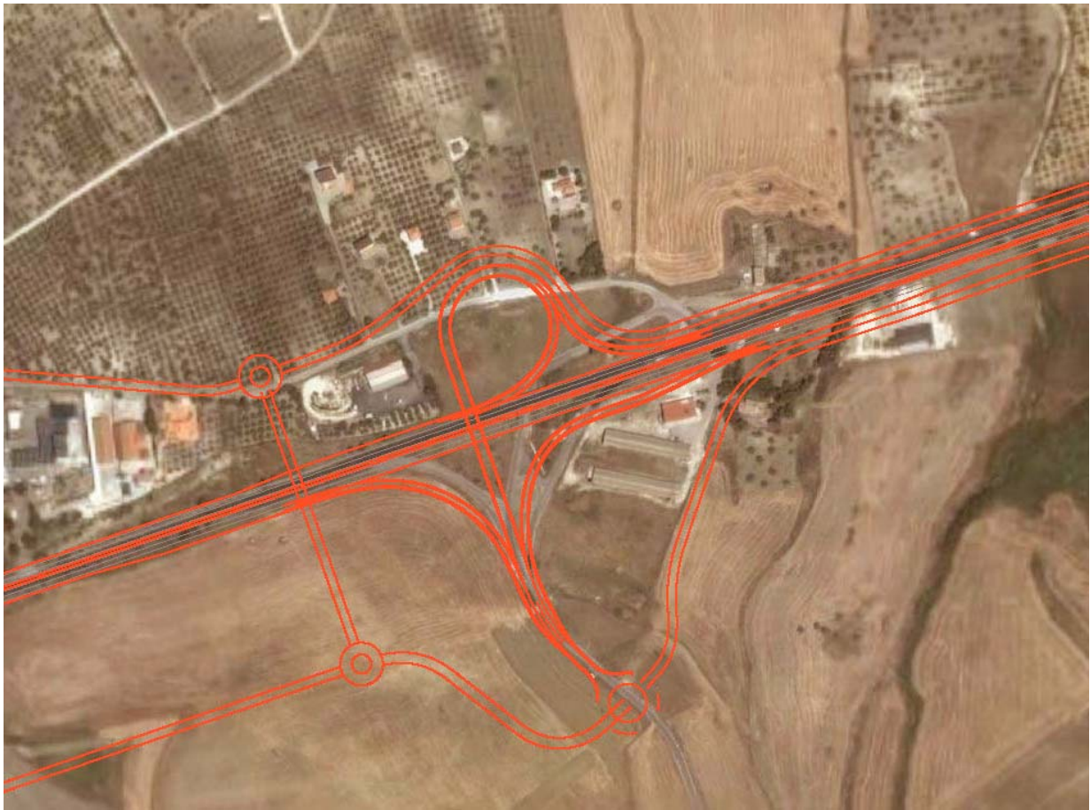
Figura 7-4: Svincolo 2 - Stato di Progetto
