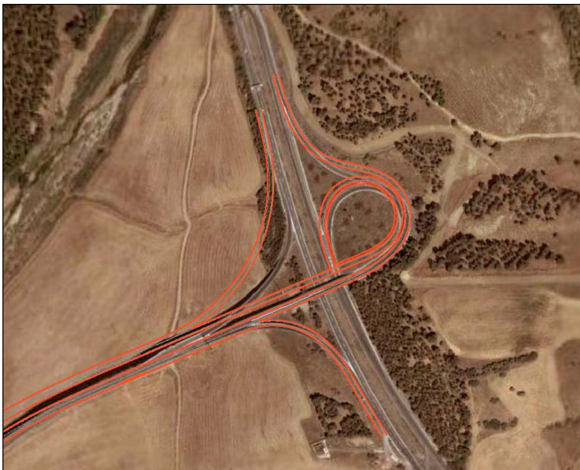
Figura 7-13: Svincolo 6 - Stato di Progetto
