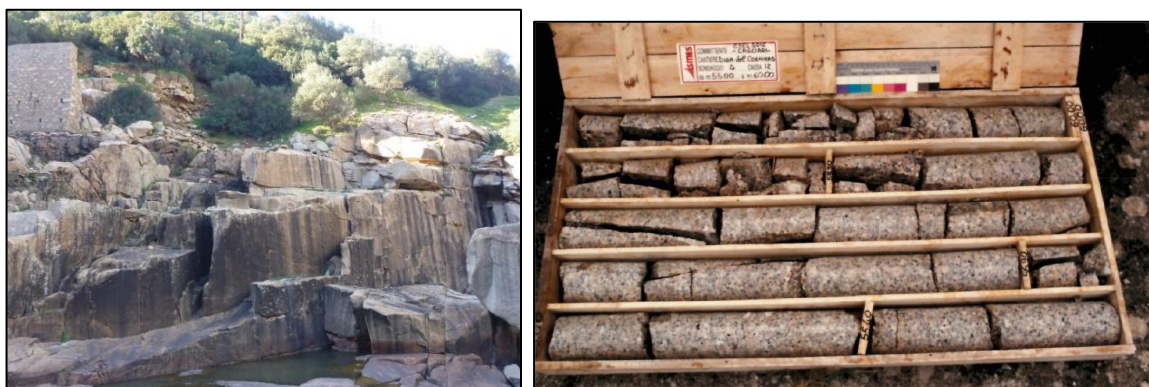
Figura 16: Struttura dell'ammasso roccioso granitico in sponda destra e da campioni di perforazione nel sondaggio S4.
