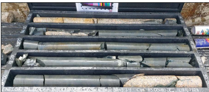
Figura 18: Filone basico osservato in affioramento e carote recuperate nel sondaggio P1.
