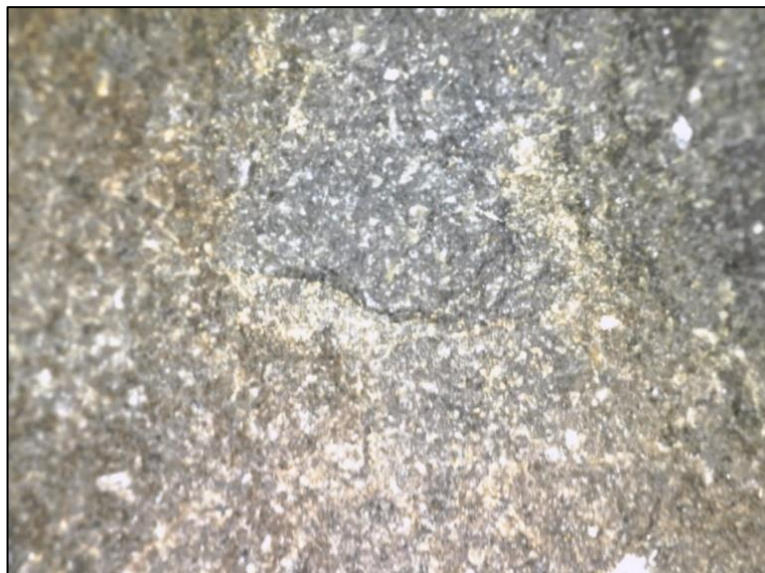
Figura 17: Scansione da microscopio ottico a ingrandimento 50X di un campione di diabase proveniente da un filone sub-verticale. Dimensione dell'immagine=25x20mm.
