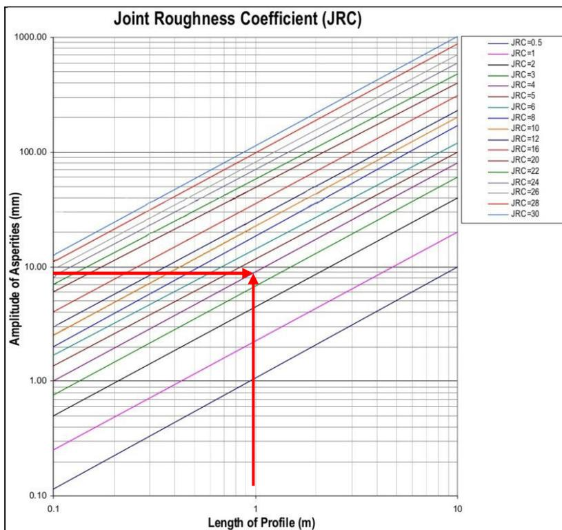
Figura 6: grafico per il calcolo del JRC di Barton [1].
