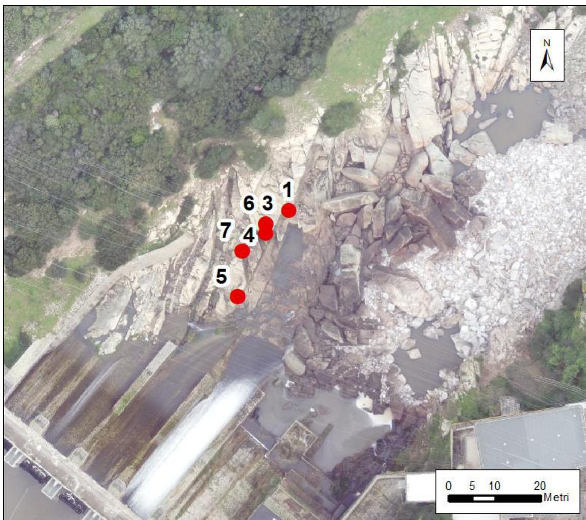
**Figura 16:** Posizioni dei giunti rilevati.
