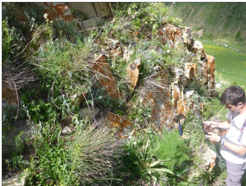
**Figura 1:** esempio di misura delle discontinuità con app per tablet.
