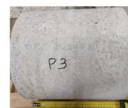
Dal campione è stato ricavato un provino di altezza 310 mm, sottoposto a prova di compressione in laboratorio.
