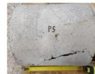
Dal campione di diametro 100 mm è stato ricavato un provino di altezza 94,4 mm sottoposto a prova di compressione in laboratorio; dal campione di diametro 300 mm è stato ricavato un provino di altezza 305,0 mm anch'esso sottoposto a prova di compressione in laboratorio
