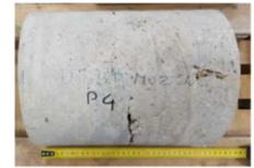
Dal campione di diametro 100 mm è stato ricavato un provino di altezza 95,8 mm sottoposto a prova di compressione in laboratorio; dal campione di diametro 300 mm è stato ricavato un provino di altezza 305,0 mm anch'esso sottoposto a prova di compressione in laboratorio
