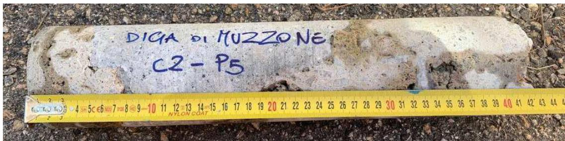
Diametro perforazione = 300 mm
