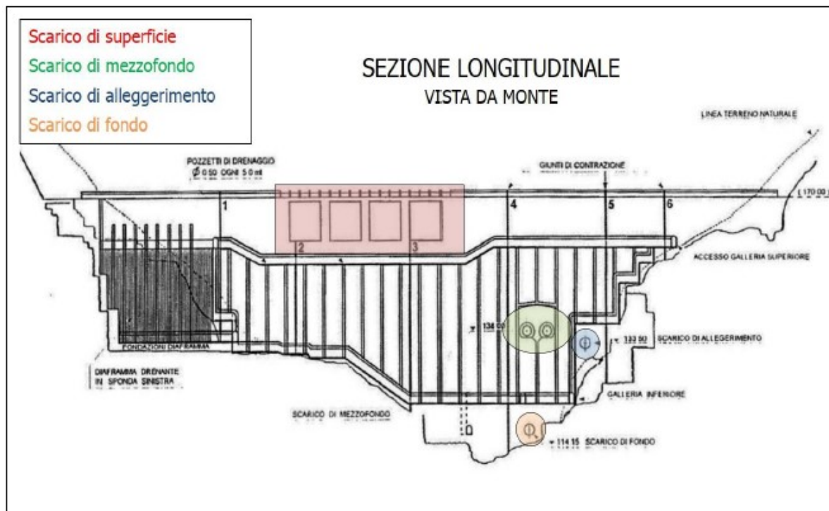
Figura 3: Sezione longitudinale del paramento di monte della diga di Muzzone.
