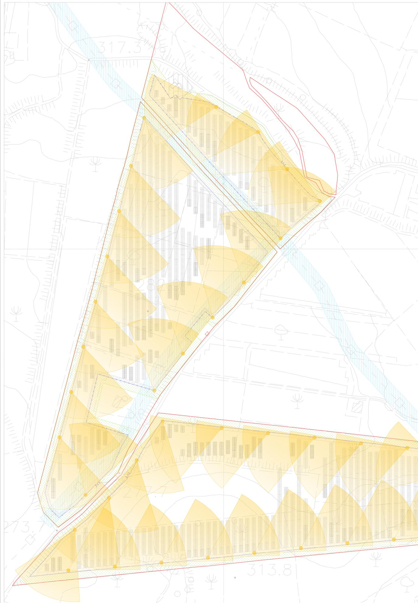
POSIZIONAMENTO IR CAMERA NEI LOTTI 1 - 2 - 3, SU C.T.R. - SEZIONI: 637150 "MASSERIA GRANDE", 637160 "MONTE DEI DRASI", 642030 "MONTE DURRÀ" E 642040 "MONTE ARATATO DEL MURO" | SCALA 1:1.000
