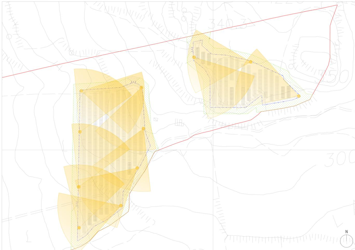
POSIZIONAMENTO IR CAMERA NEI LOTTI 4 - 5, SU C.T.R. - SEZIONI: 637150 "MASSERIA GRANDE", 637160 "MONTE DEI DRASI", 642030 "MONTE DURRÀ" E 642040 "MONTE ARATATO DEL MURO" | SCALA 1:1.000
