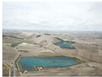
Fotosimulazioni dell'impianto con moduli in silicio policristallino.
