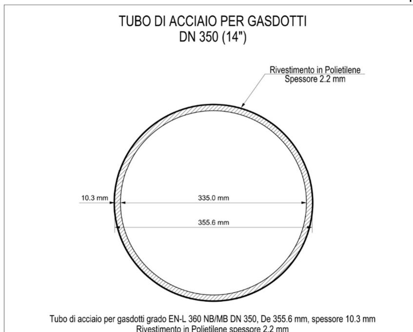
**Fig. 8.1** – Sezione tipica tubo di acciaio DN 350 (14").
