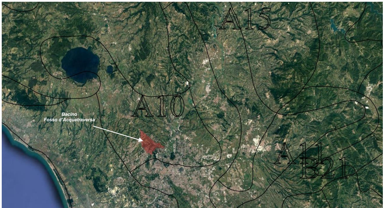
Figura 6 – Sottobacino di interesse del Fosso d'Acquatraversa vs sottozone omogenee VAPI Italia Centrale.
