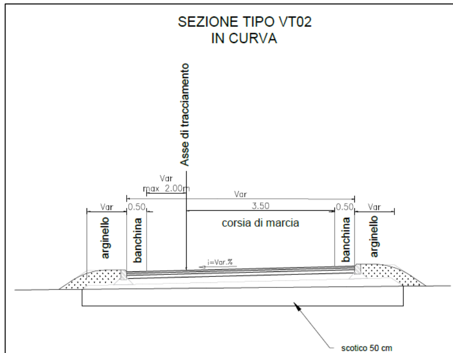
Fig. 6. Sezione tipo in rilevato VT02
