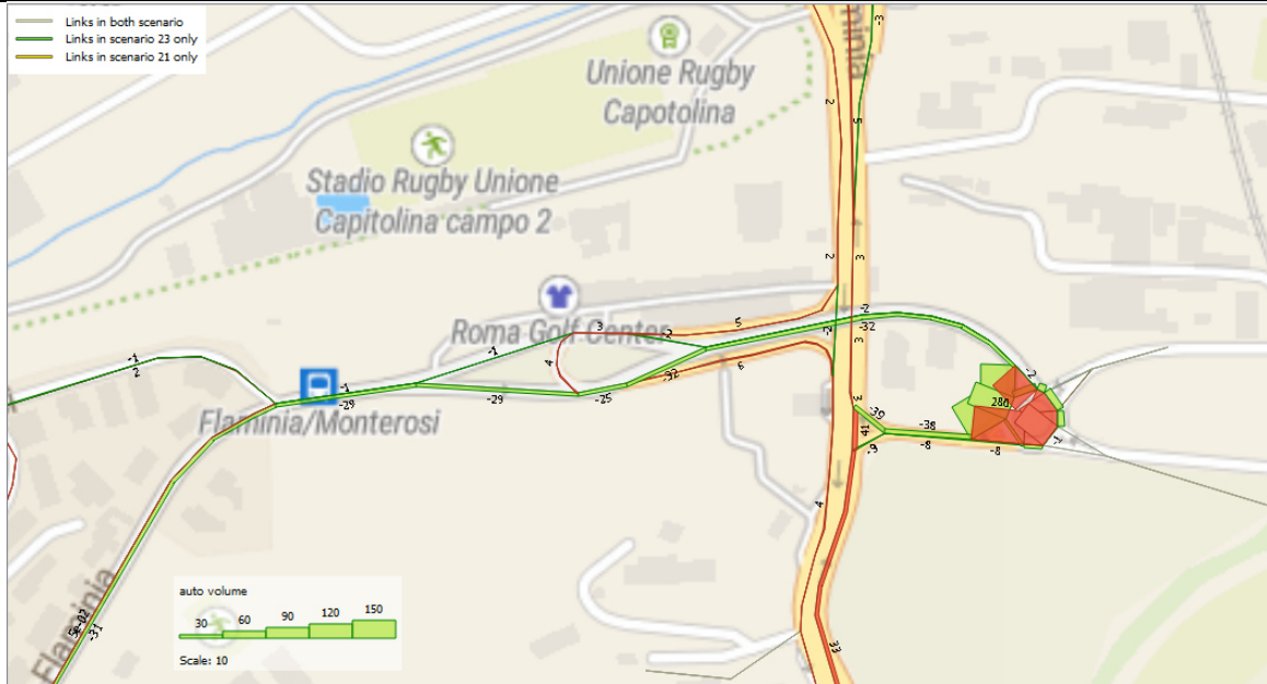
Figura 23. Lotto 1 – Scenario 2 Via di Tor di Quinto: differenza flussi rispetto a scenario di non progetto (ora di punta pomeriggio)
