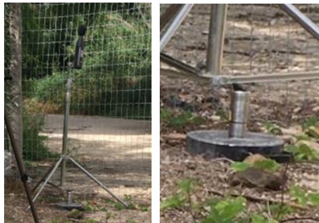
Figura 3-2 Esempio di installazione dell'accelerometro
