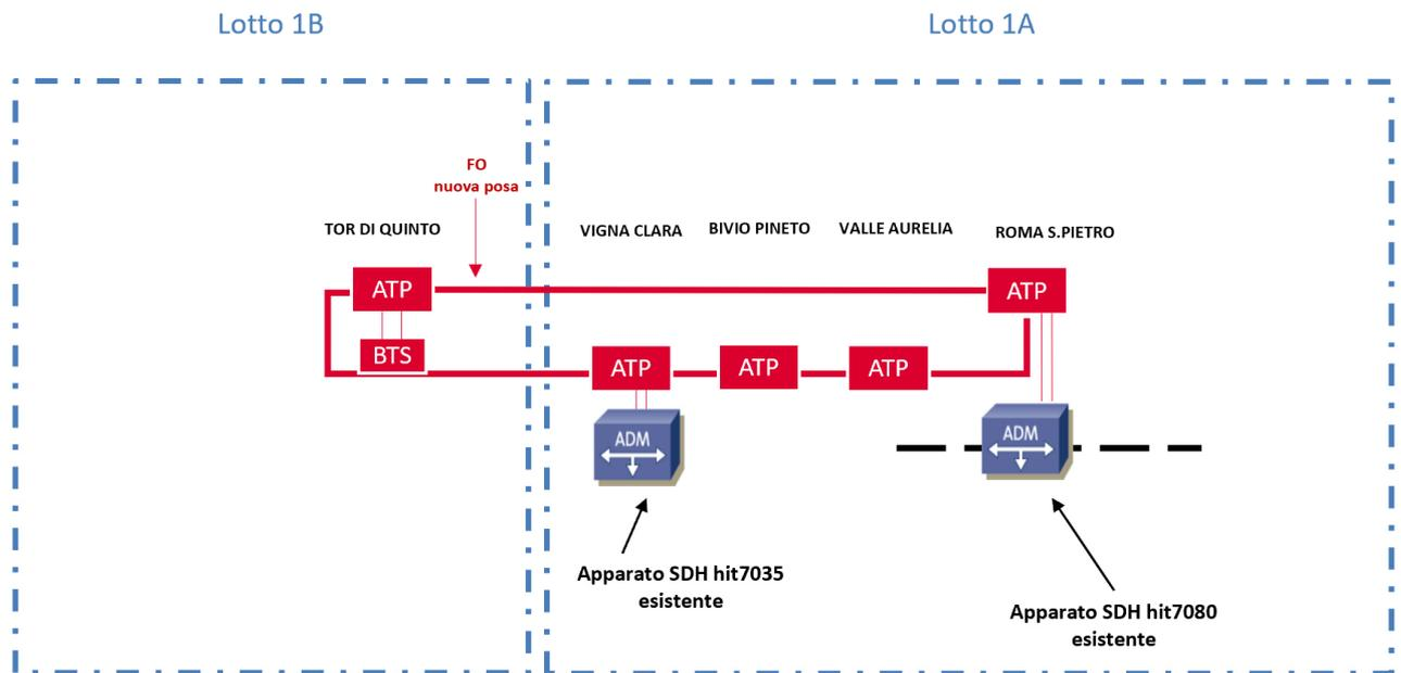
Figura 3: Architettura della rete di trasporto MPLS-TP
