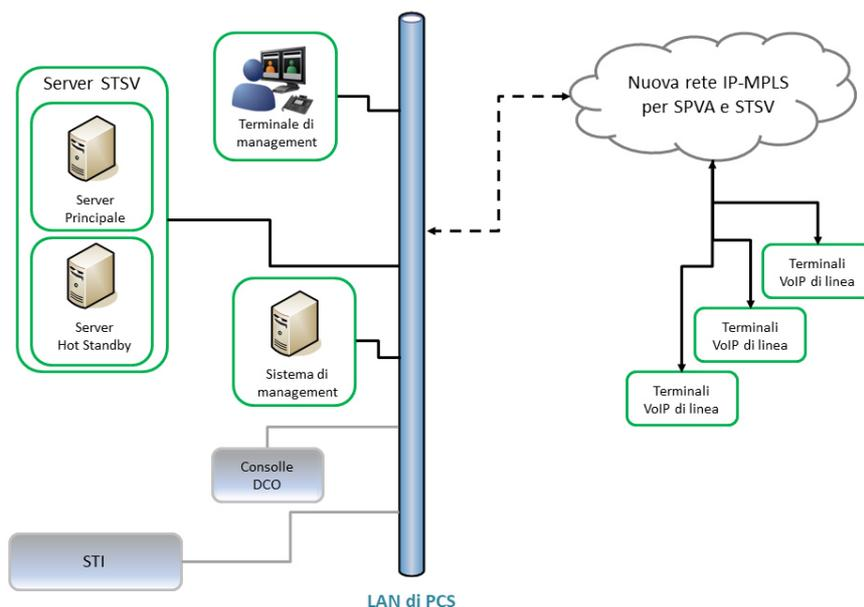
**Figura 3: Architettura Sistema Telefonia Selettiva STSV**
