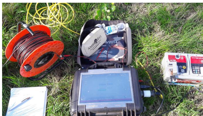
Figura 2.1.2.2: Sismografo digitale a 24 bit.
