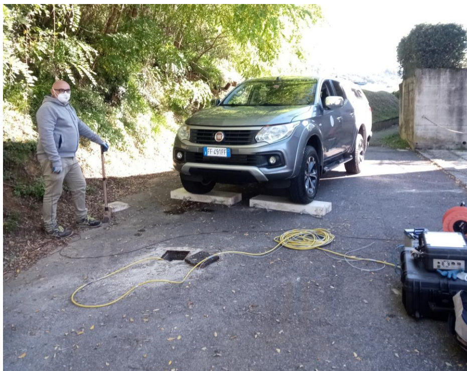
Figura 2.1.2.1: configurazione standard per le indagini Down Hole
