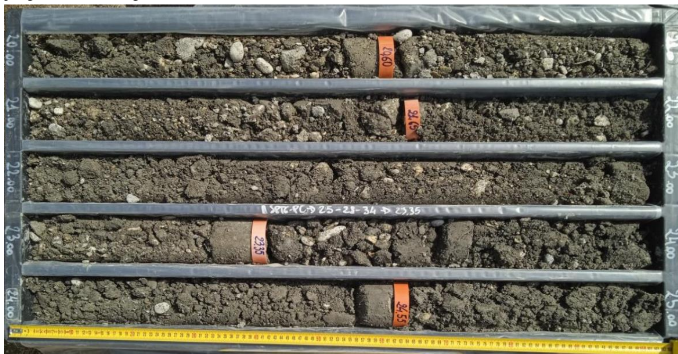
Figura 11 – La litofacies ghiaioso-sabbiosa dei Depositi alluvionali recenti (bb1) nella cassetta 5 del foro di sondaggio L1BPS02BH, tra 20.0 e 25.0 m dal p.c..
