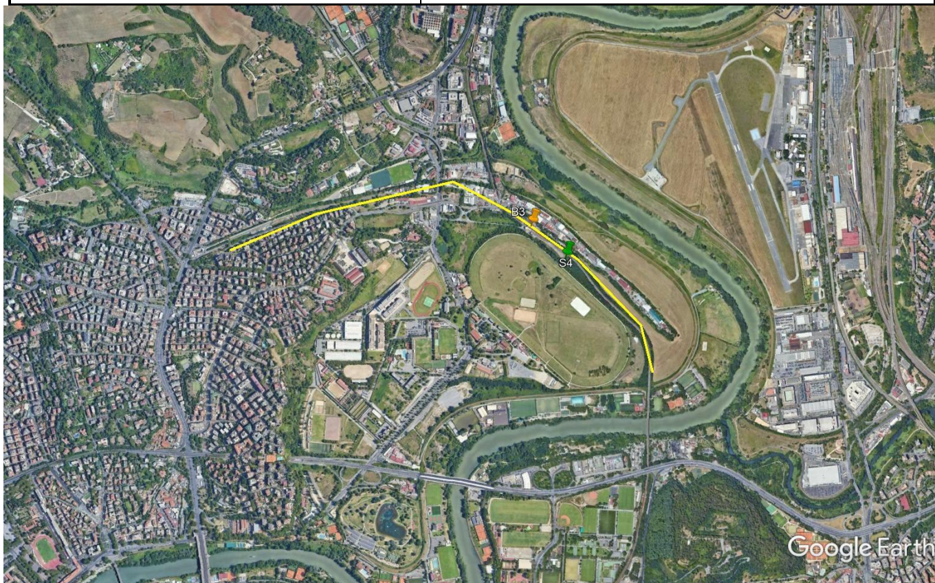
Figura 7-1 - Ubicazione dei sondaggi ambientali (S, in verde) campionati nell'area di intervento e ubicazione dei punti di campionamento del sub-ballast (terreno dal rilevato ferroviario) e del ballast (pietrisco ferroviario) coincidenti tra loro (punti denominati B, in arancione).
