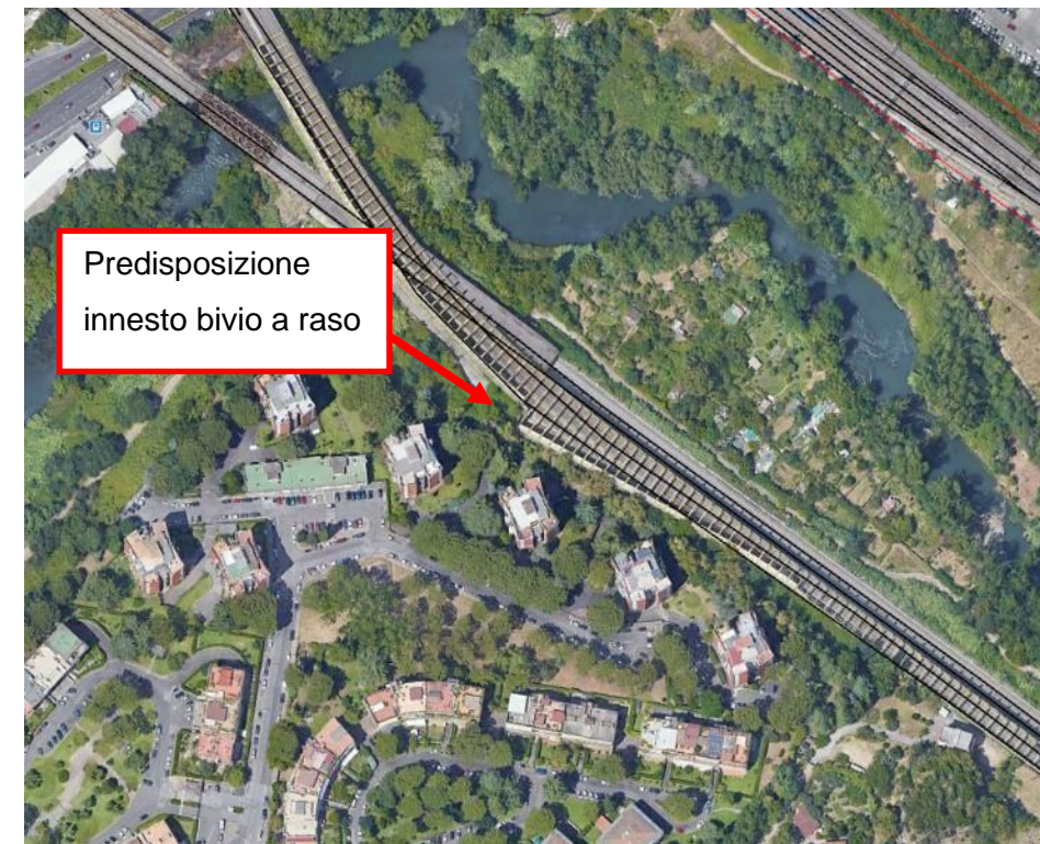
Figura 4-1: Dettaglio innesto bivio a raso
