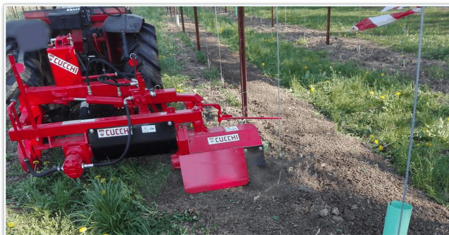
Figura 4 esempio di macchina operatrice con fresa interfilare per la pulizia dell'area al di sotto dei pannelli
