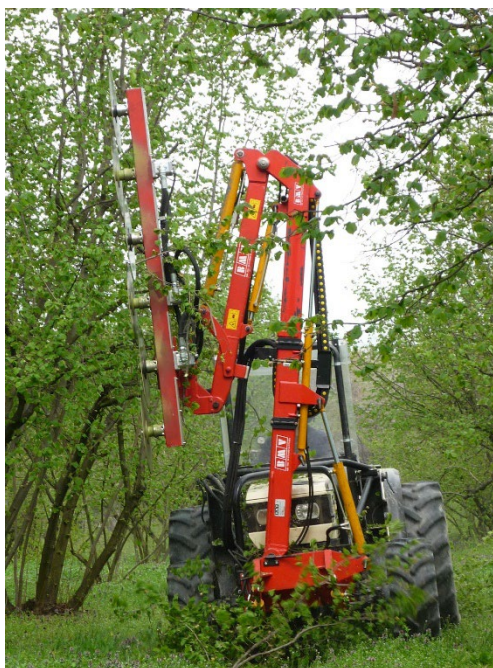
Tav. 19 Esempio di potatrice meccanica frontale a doppia barra (taglio verticale + topping) utilizzabile su tutte le colture arboree intensive
