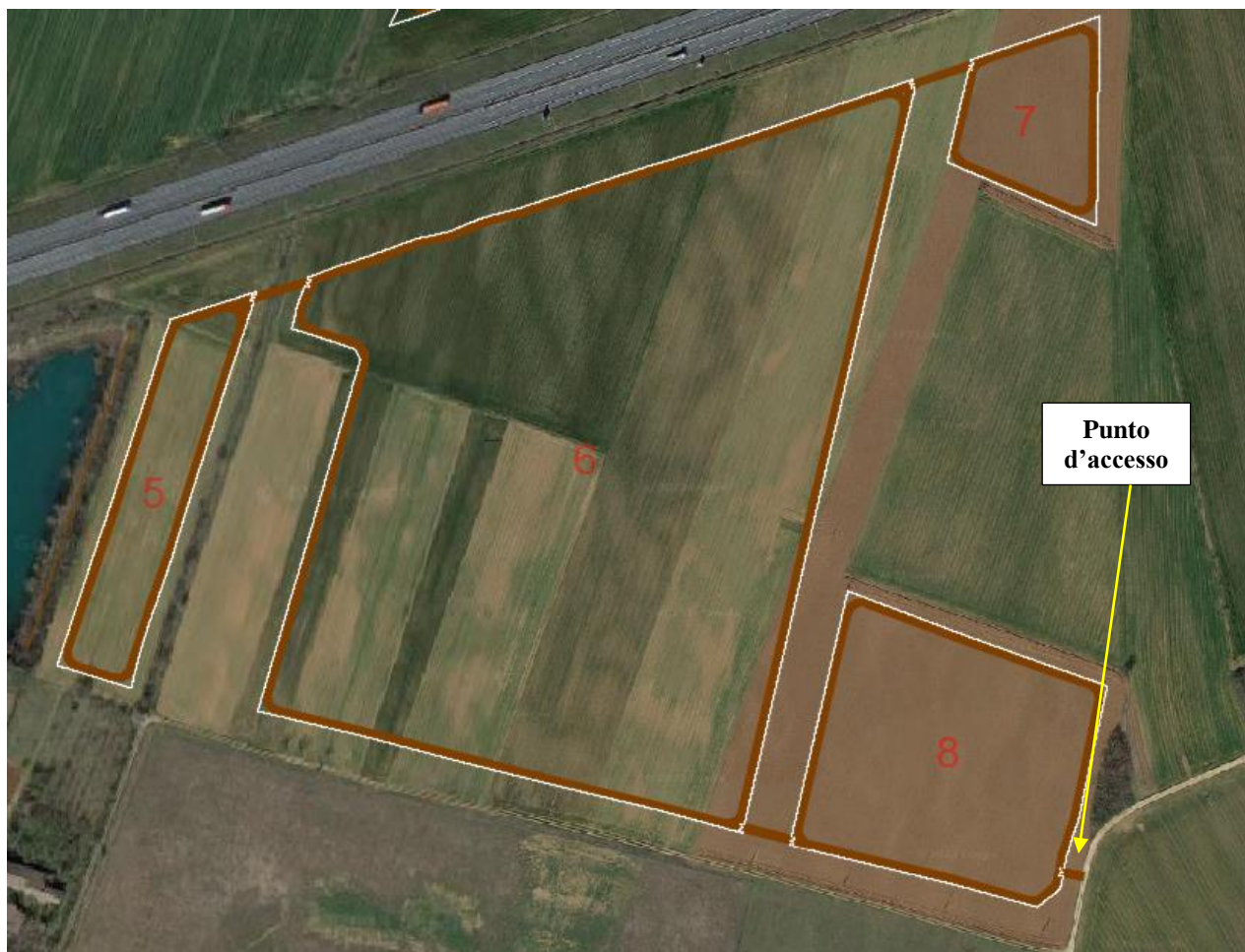
Figura 4-7 – Accessi al sito per il sottocampo 5, 6, 7 e 8 dell’impianto fotovoltaico. In bianco la recinzione, in marrone la viabilità interna e d’accesso al sito
