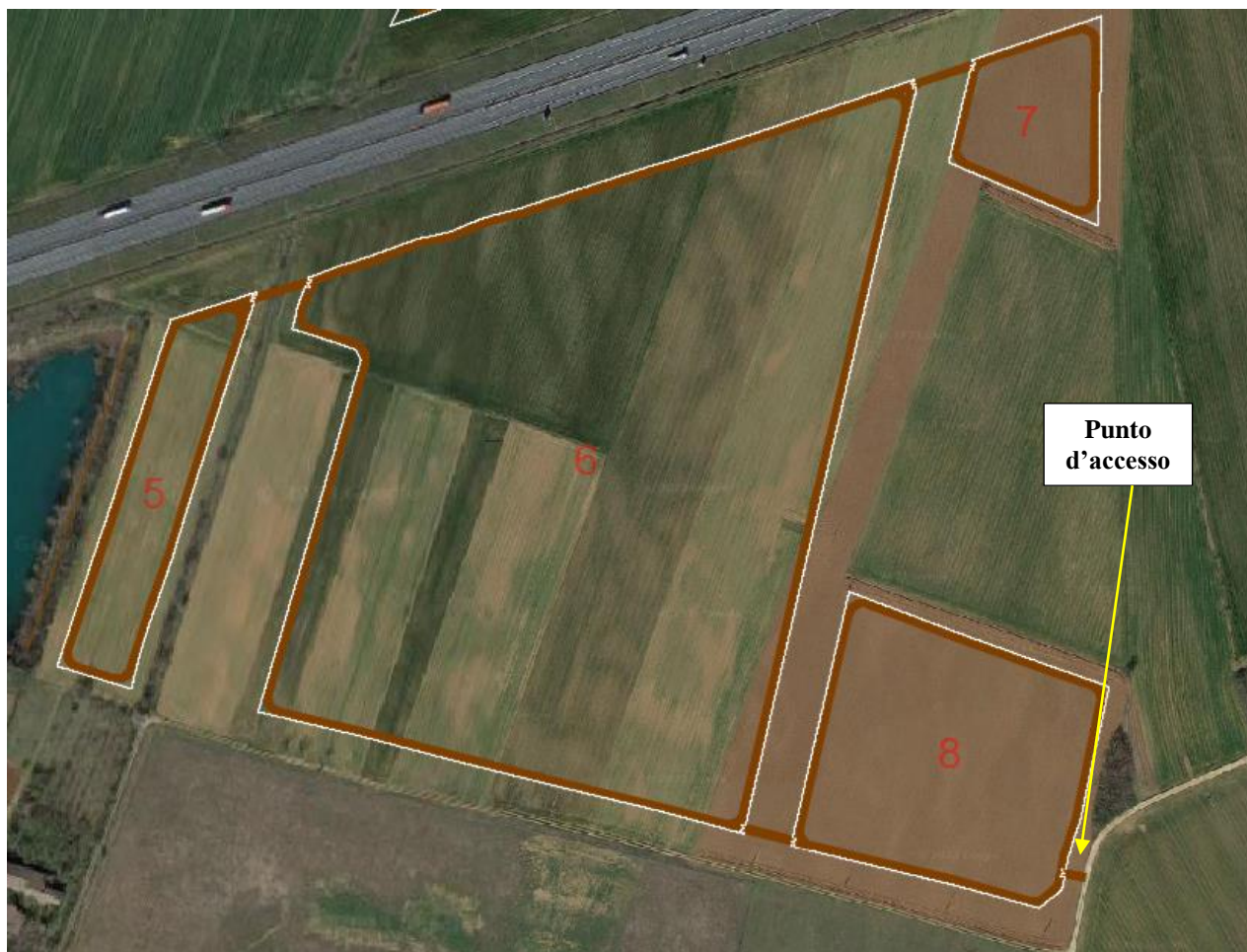
Figura 4-9 – Accessi al sito per i lotti 5, 6, 7 e 8 dell’impianto fotovoltaico. In bianco la recinzione, in marrone la viabilità interna e d’accesso al sito
