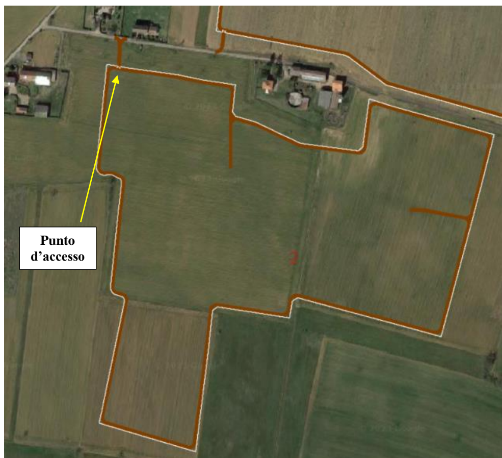
Figura 5-4 – Accessi al sito per il sottocampo 2 dell’impianto fotovoltaico da Strada dei Bandetti. In bianco la recinzione, in marrone la viabilità interna e d’accesso al sito
