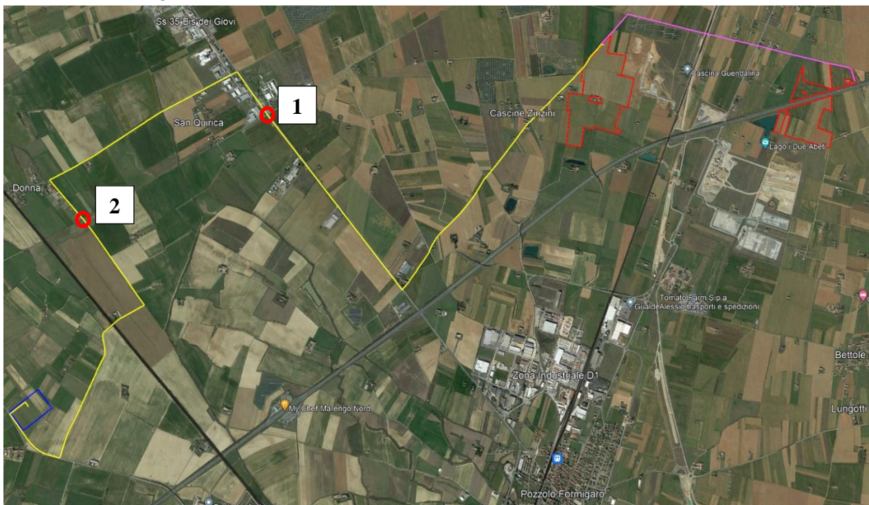
Figura 7-3 – Percorso tracciato cavidotto 36 kV (in giallo) di collegamento alla SE Mandrino (rettangolo blu) della RTN. I cerchi in rosso indicano i punti di attraversamento con la via storica “Aemilia Scauri”
