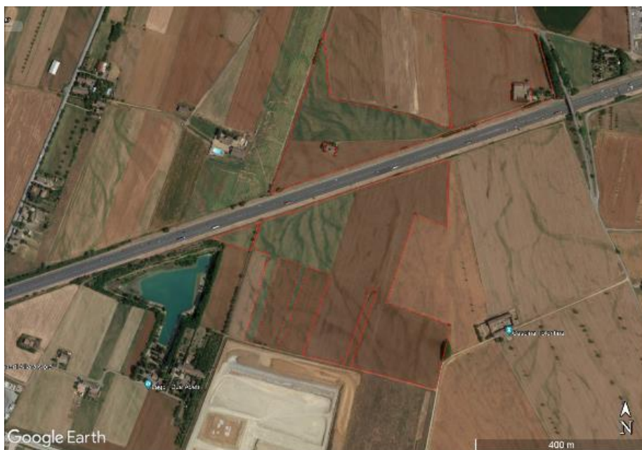
Figura 4-10 – Linee di deflusso delle acque superficiali per eventi di pioggia intensi, nell'area della Cascina Cipollona, lotto est, da Google Earth del 10 giugno 2017.
