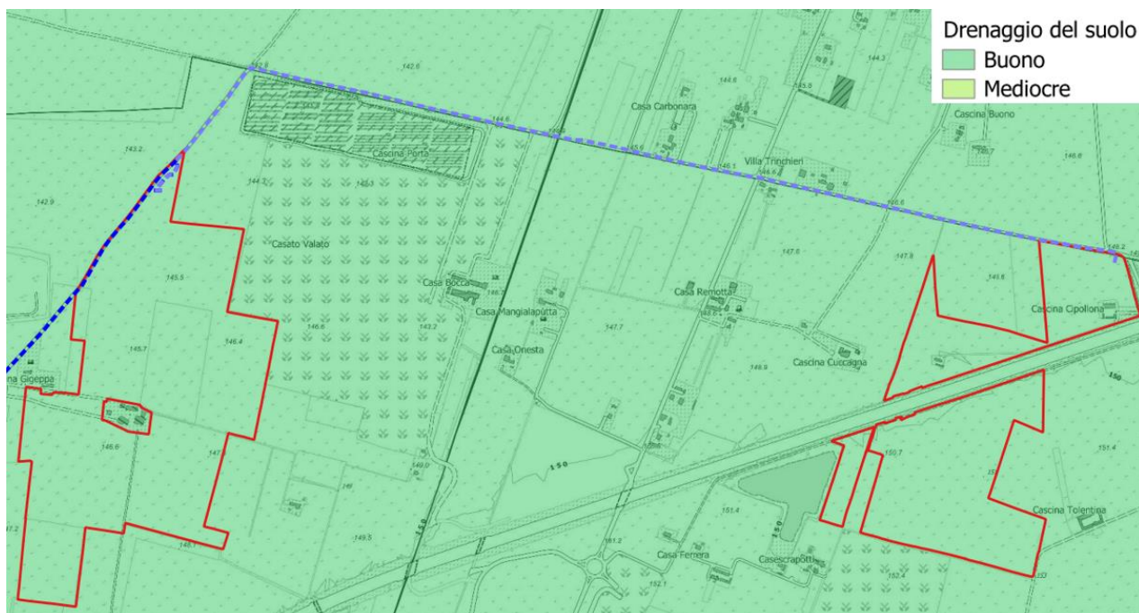
Figura 7-32 – Inquadramento progetto “La Cipollona” su carta dei suoli indicante la capacità di drenaggio: in rossi confini catastali, in azzurro il tracciato di interconnessione dei due macrolotti d’impianto e in blu il tracciato di connessione alla Nuova SE “Mandrino”
