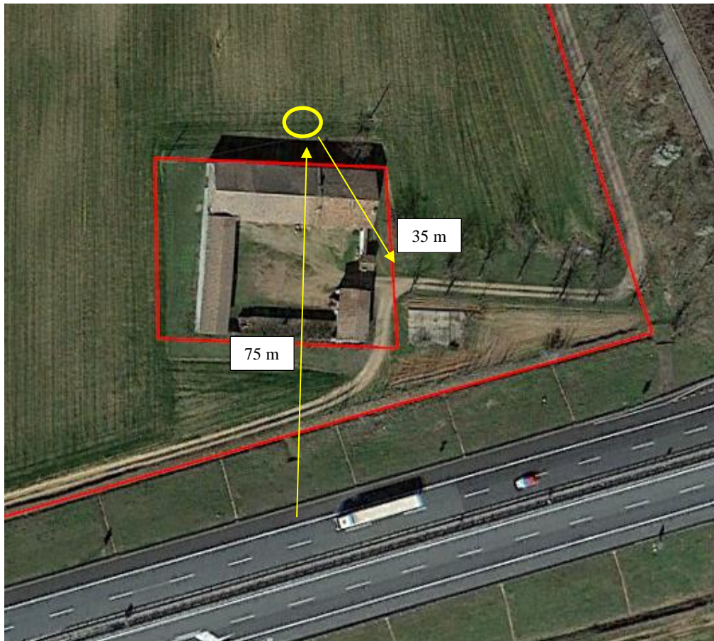
Figura 9-1 – Distanze tra il fonometro (cerchio in giallo) posizionato presso il ricettore cascina Cipollona dalla carreggiata autostradale
