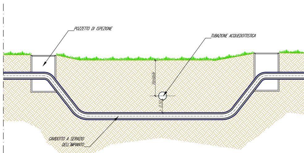
SEZIONE TIPO DELLA POSA DEL CAVIDOTTO PER IL SUPERAMENTO
