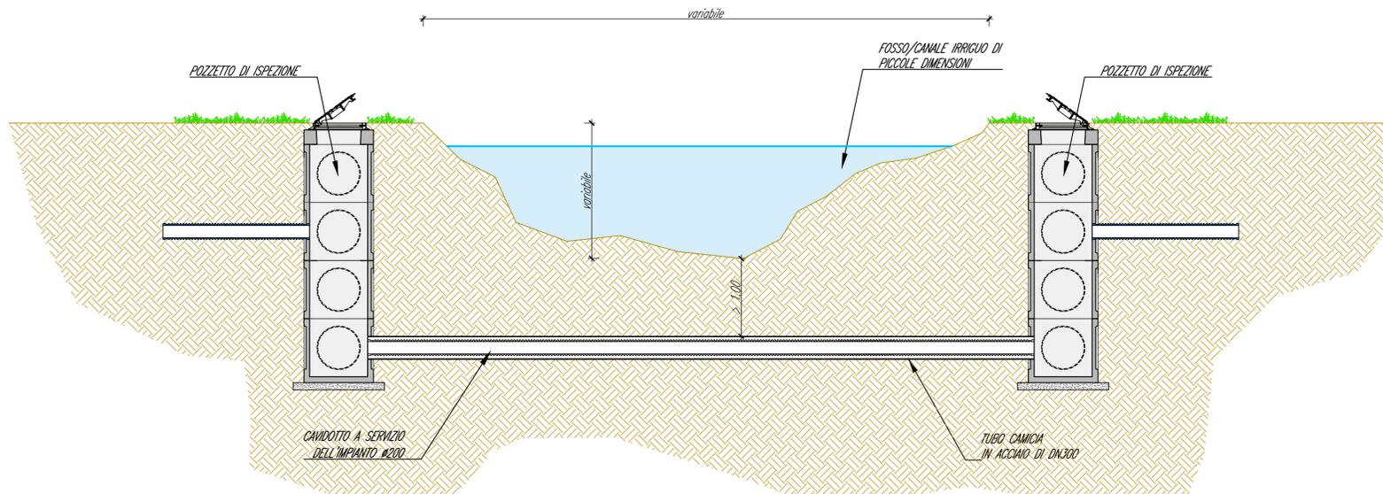
SEZIONE TIPO DELLA POSA DEL CAVIDOTTO IN SUBALVEO AL DI SOTTO
