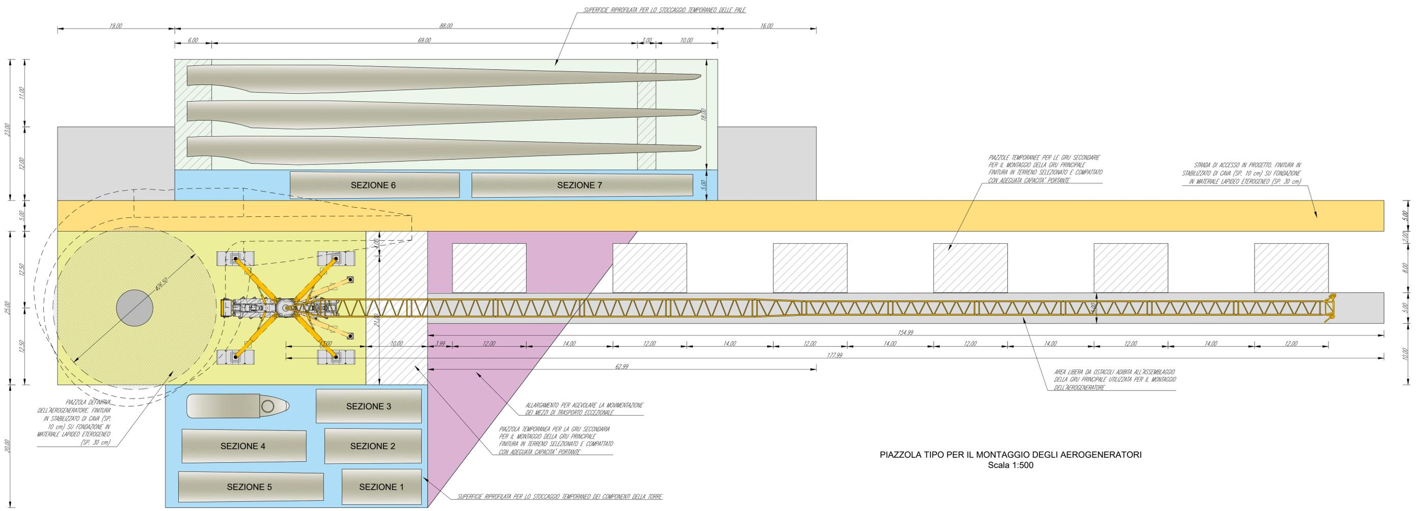
PIAZZOLA TIPO PER IL MONTAGGIO DEGLI AEROGENERATORI
