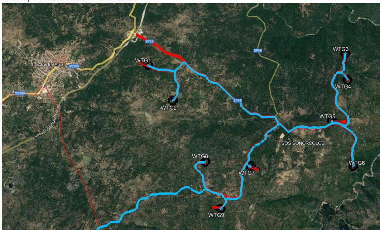
Figura 2 Vista satellitare del parco eolico "Buddusò sud I" con posizioni degli aerogeneratori, viabilità di accesso esterna (in rosso) e viabilità interna al parco (in azzurro il cavidotto interrato che si snoda per quasi la totalità al di sotto della pista sterrata di accesso agli aerogeneratori)
