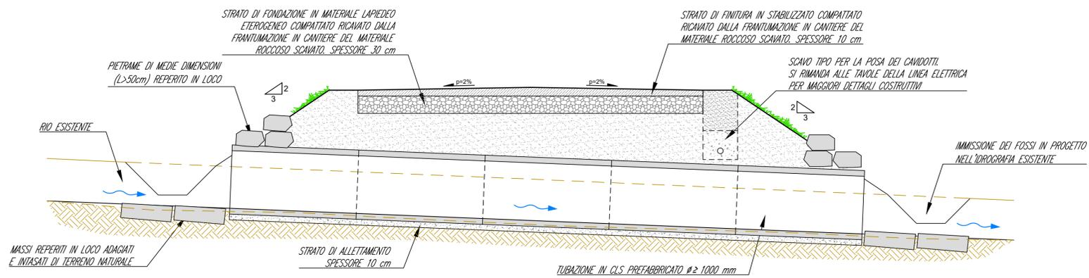
SEZIONE TIPO DELLA STRADA IN RILEVATO CON ATTRAVERSAMENTO
