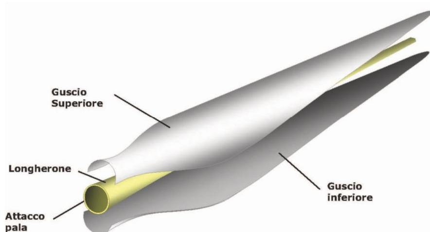
**Figura 1 - Schema strutturale di una pala eolica.**
