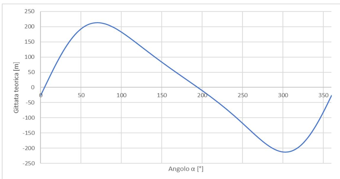
**Figura 4 – Calcolo della gittata in funzione dell'angolo  $\alpha$  sotteso dalla pala (posizione della pala al momento della rottura).**
