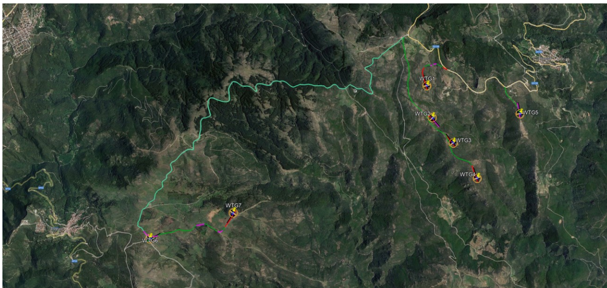
Figura 5 – Vista satellitare del parco eolico “Serra Joni con posizioni degli aerogeneratori e viabilità interna al parco (in verde strade esistenti da adeguare, in rosso nuova viabilità e in magenta modifiche temporanee a brevi tratti di viabilità esistente funzionali solo alla cantierizzazione).
