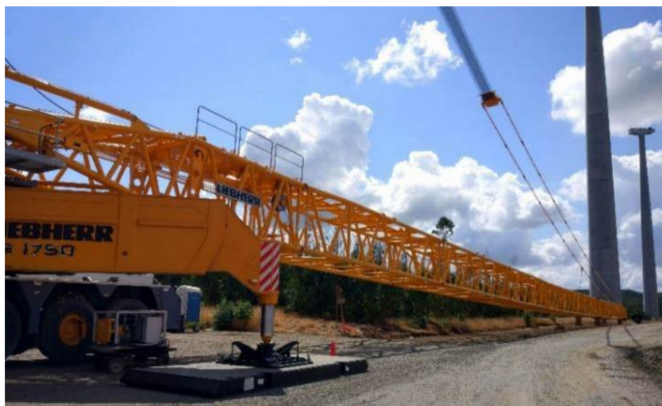
Figura 12 – Fasi di montaggio della gru principale.
