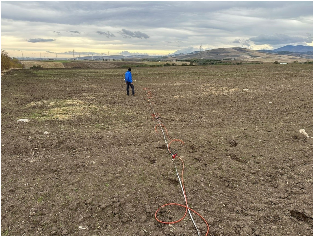
Esecuzione profilo sismico a rifrazione 2
