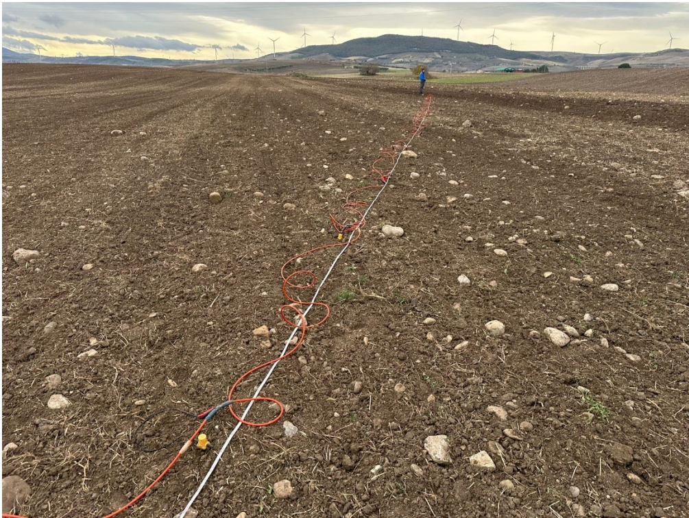
Esecuzione profilo sismico a rifrazione 4 e Masw n.2 sullo stesso stendimento
