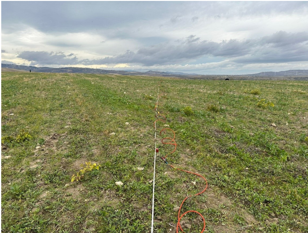
Esecuzione profilo sismico a rifrazione 5 e Masw 3 sullo stesso stendimento
