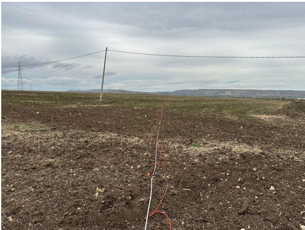
Esecuzione profilo sismico a rifrazione 1 e Masw n.1 sullo stesso stendimento
