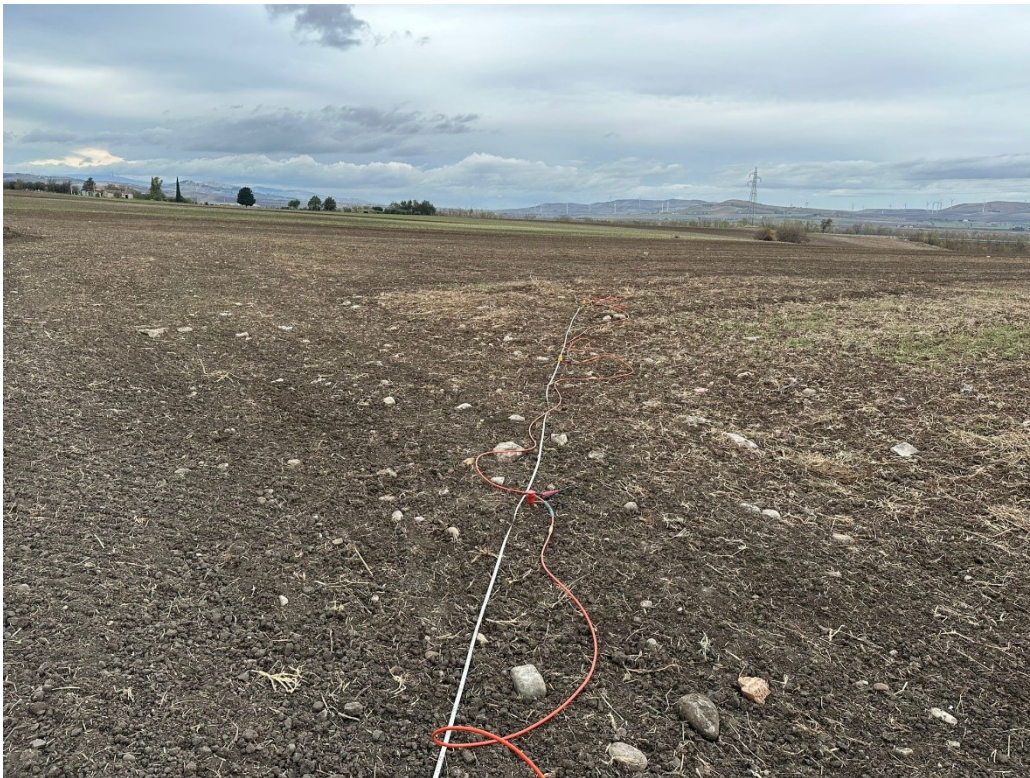
Esecuzione profilo sismico a rifrazione 3
