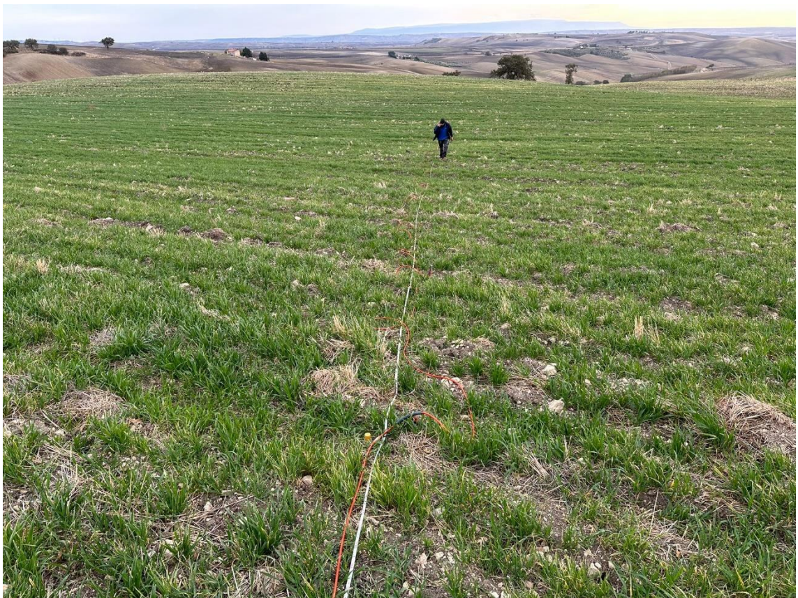
Esecuzione profilo sismico a rifrazione 6
