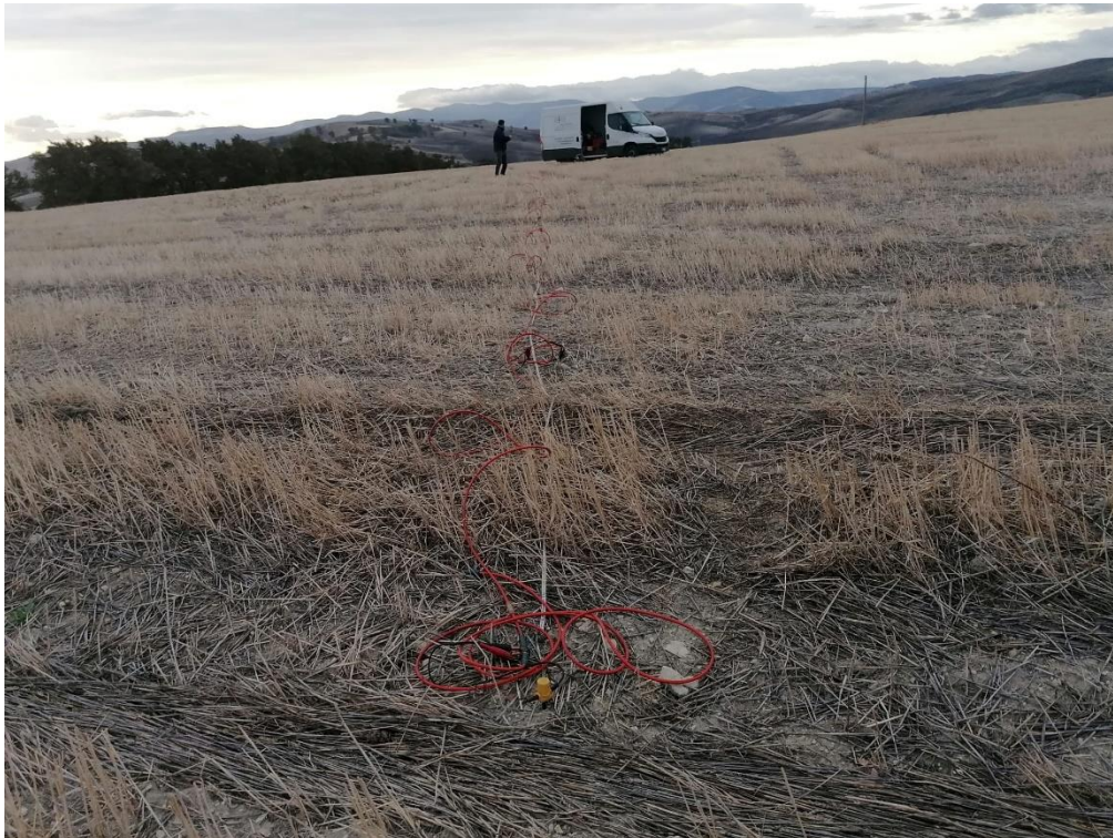
Esecuzione profilo sismico a rifrazione 2 e Masw n.2 sullo stesso stendimento
