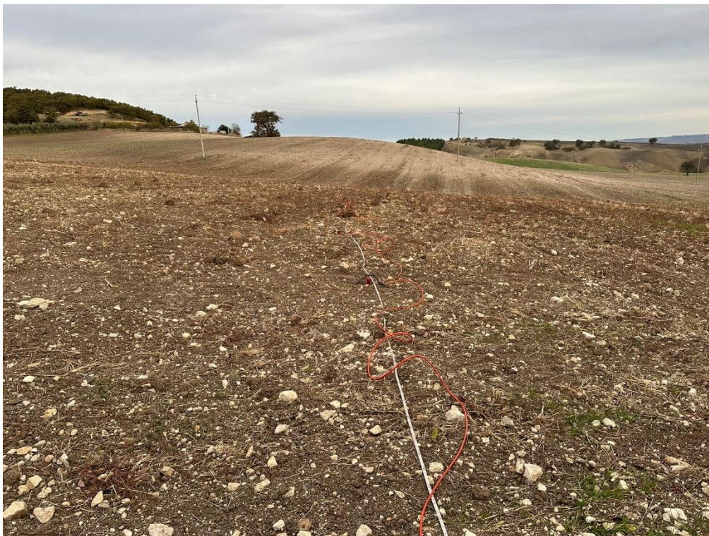
Esecuzione profilo sismico a rifrazione 4
