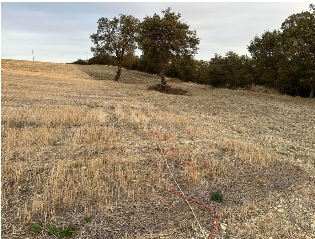
Esecuzione profilo sismico a rifrazione 3
