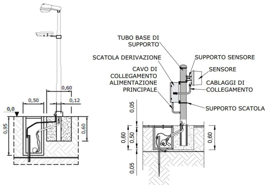
**Fig. 19 – Sistema antintrusione**
