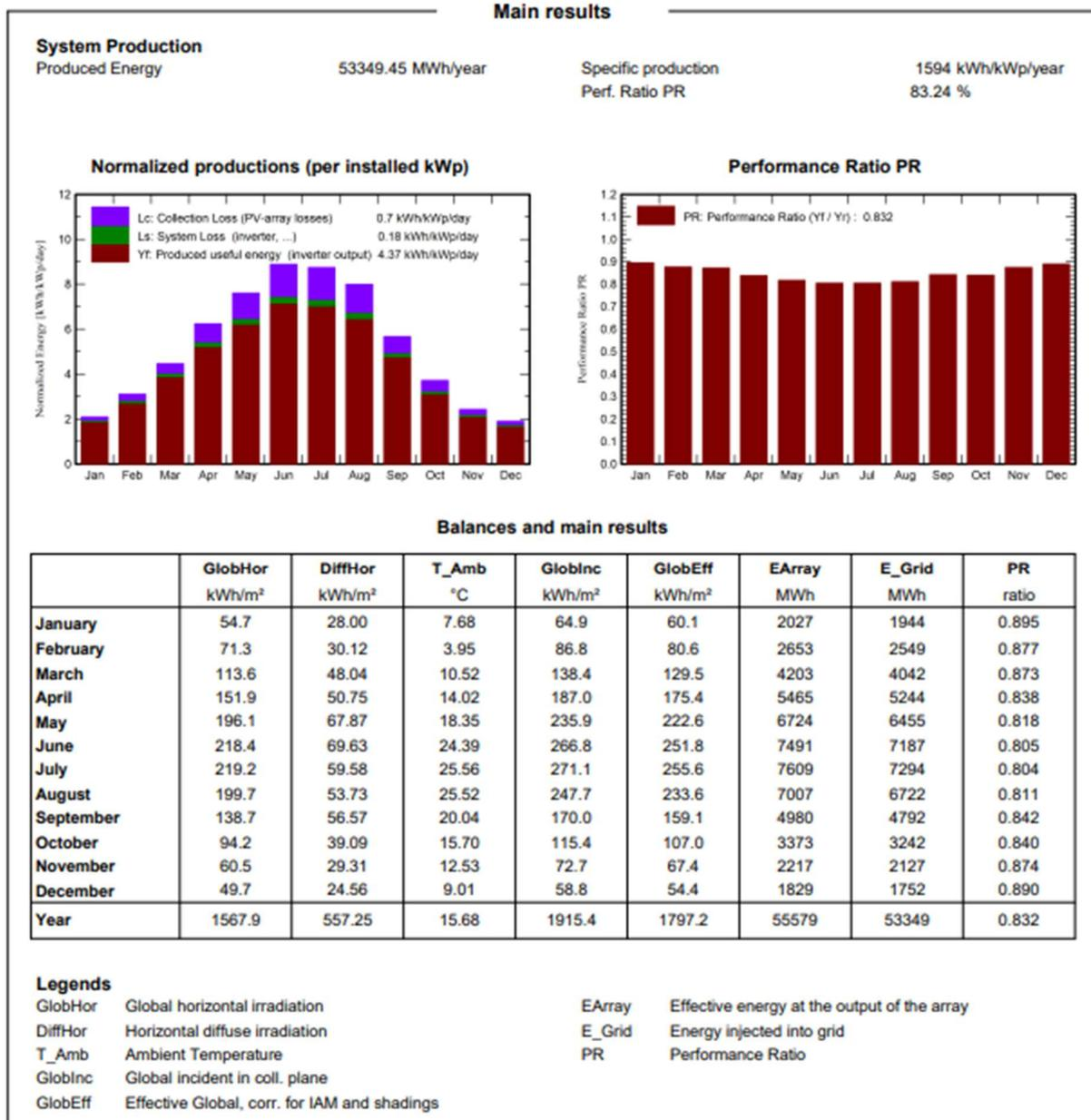
**Fig. 25 - Risultati di calcolo (Fonte: PVsyst - Solcast)**
