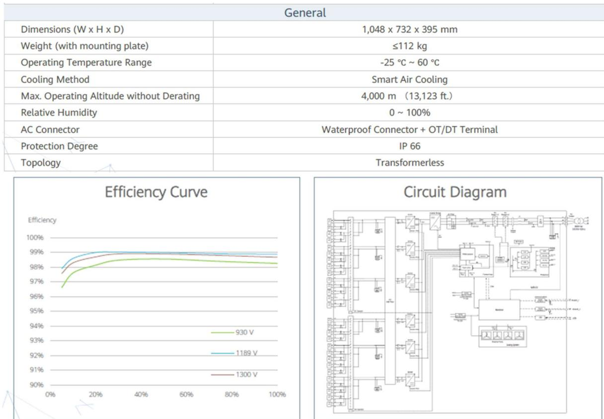
**Fig. 12 - Dimensioni, specifiche tecniche e prestazionali dell'inverter**
