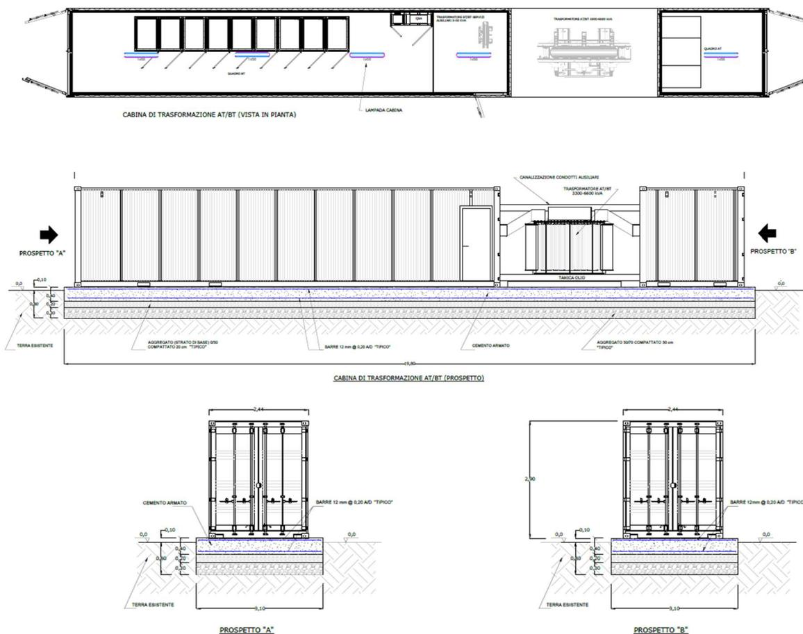
**Fig. 17 - Cabina di trasformazione BT/AT**
