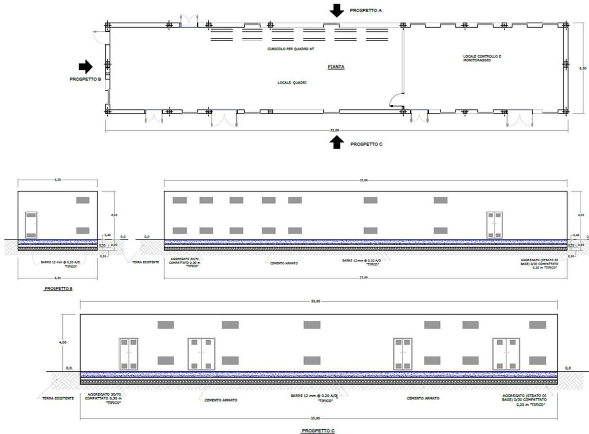
**Fig. 18 - Cabina di ricezione, sezionamento e controllo**
