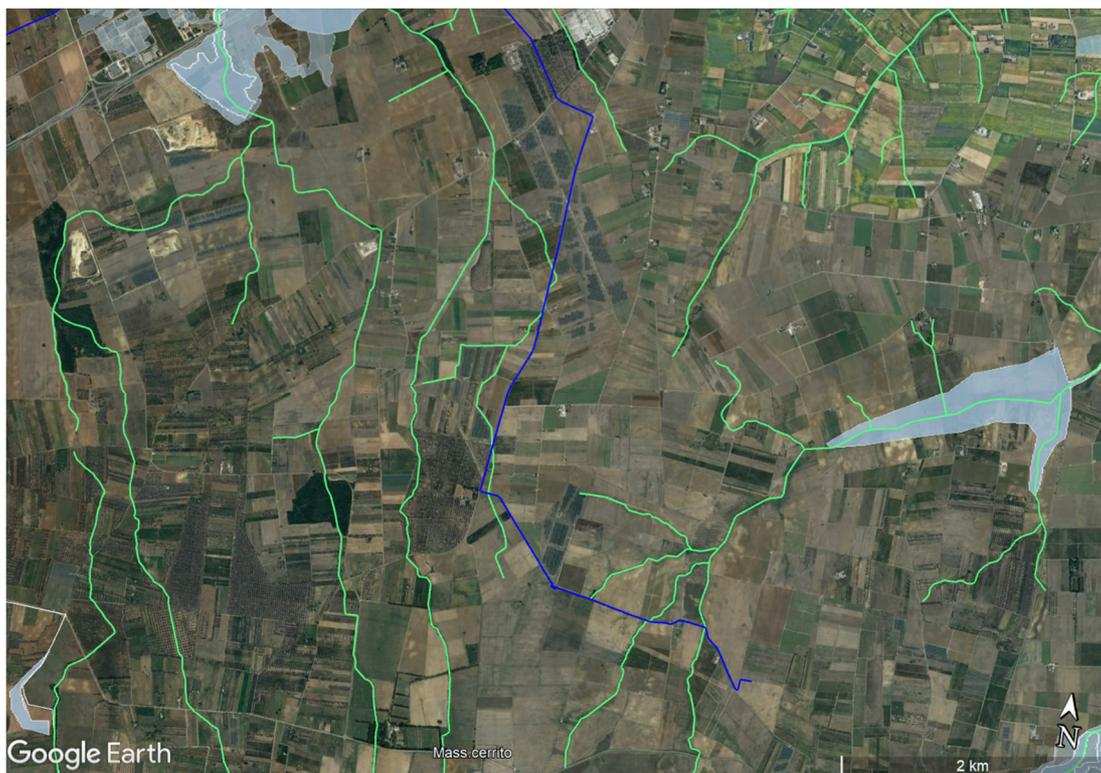
*Fig. 4.2a - Sovrapposizione tra il cavidotto e le aree AP, MP e BP (settore meridionale)*
