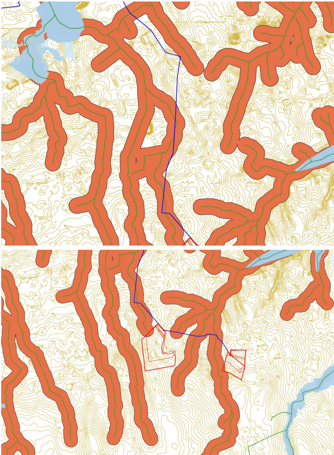
Fig. 5.2.3 - Sovrapposizione con le aree buffer di 150 m della rete idrografica
