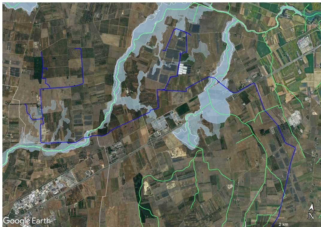
Fig. 5.2.2b - Sovrapposizione tra il caviddotto e le aree AP, MP e BP (area settentrionale)
