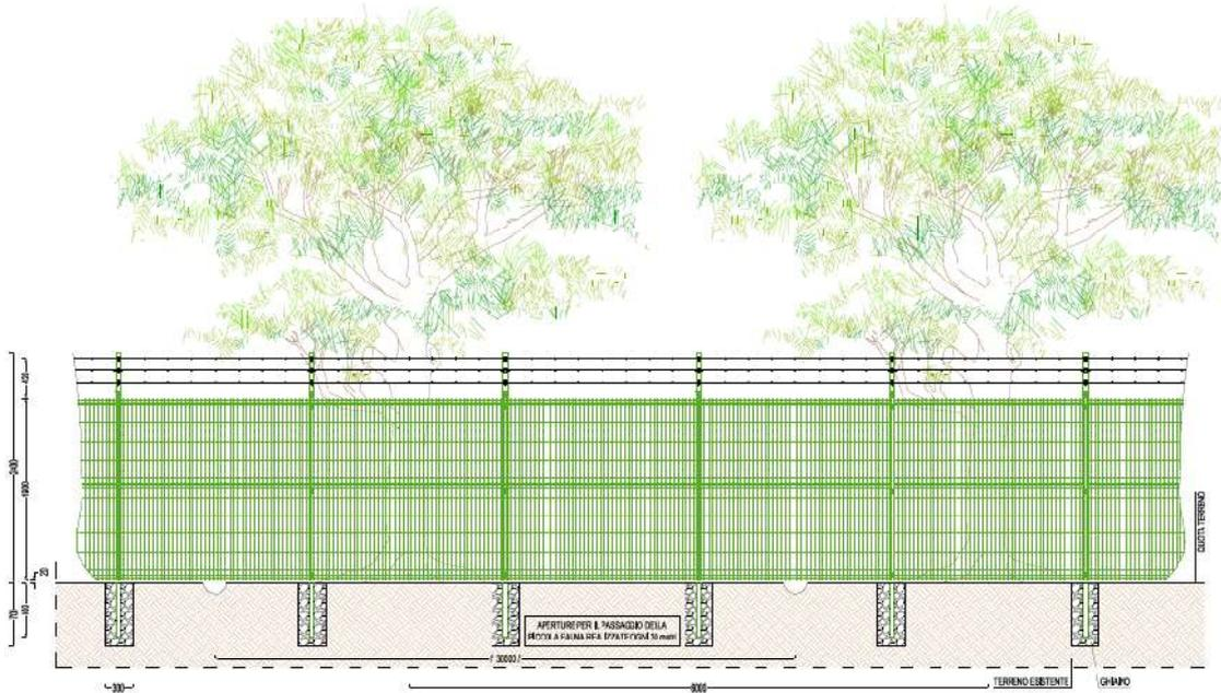
Figura 38: Prospetto recinzione con fascia di mitigazione
