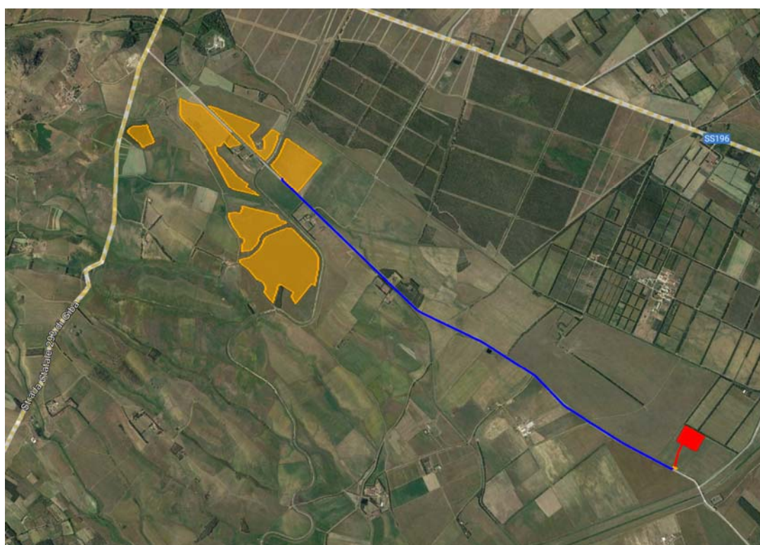
Fig. 5– Tracciato cavidotto MT verso SE
