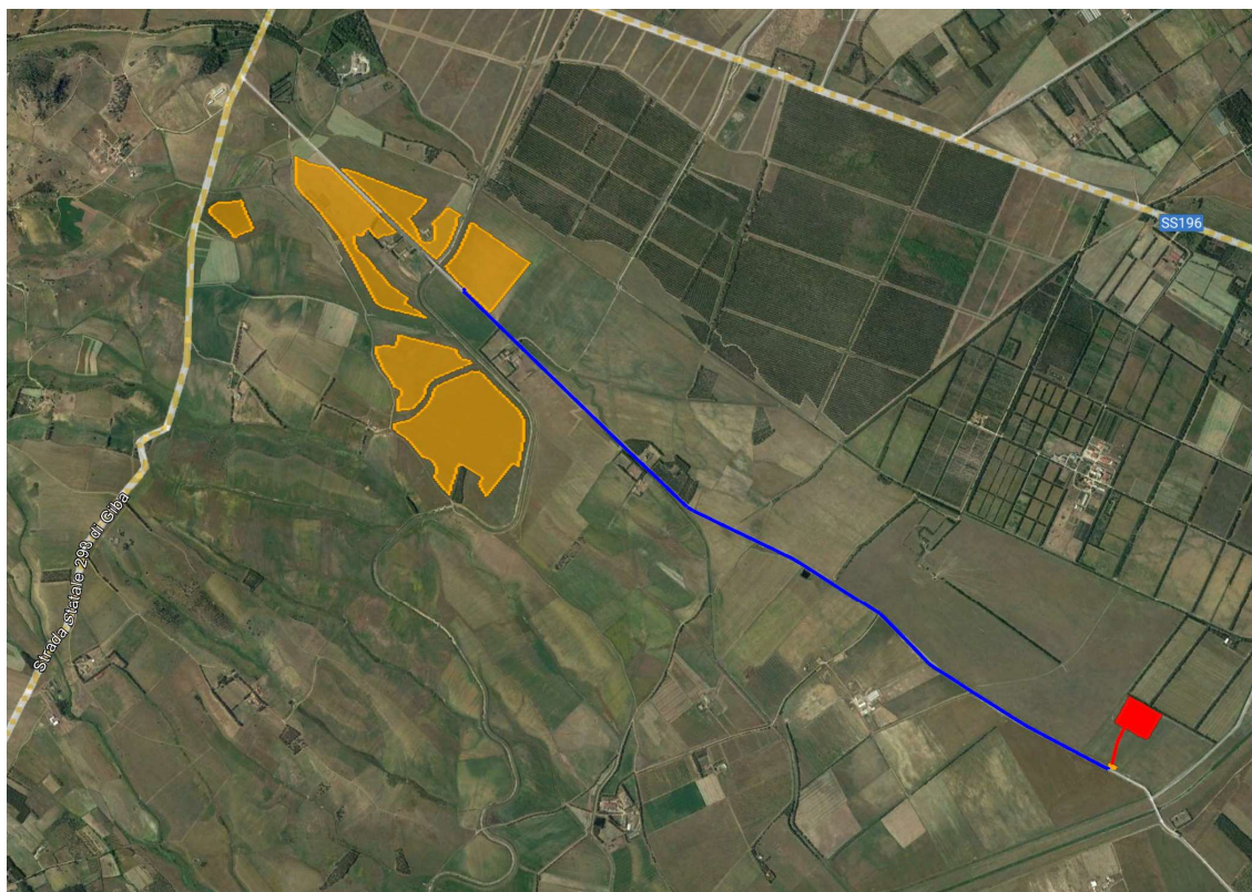
Figura 2 – Tracciato cavidotto MT verso SE
