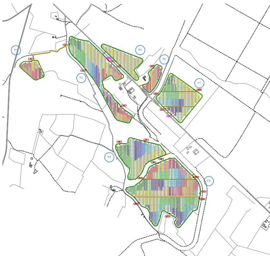
Particolare Piastre del Parco fotovoltaico
