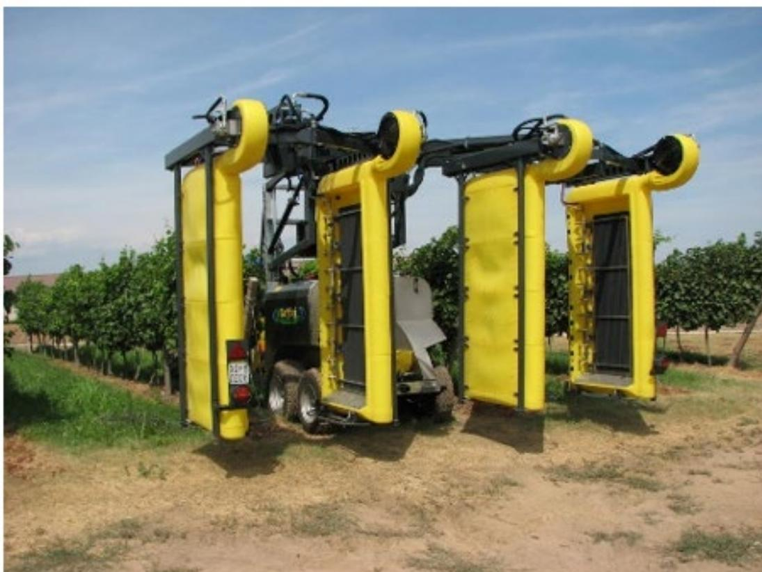
*Figura 14 - Vista di atomizzatore con barre per il recupero della deriva dei fitofarmaci*
