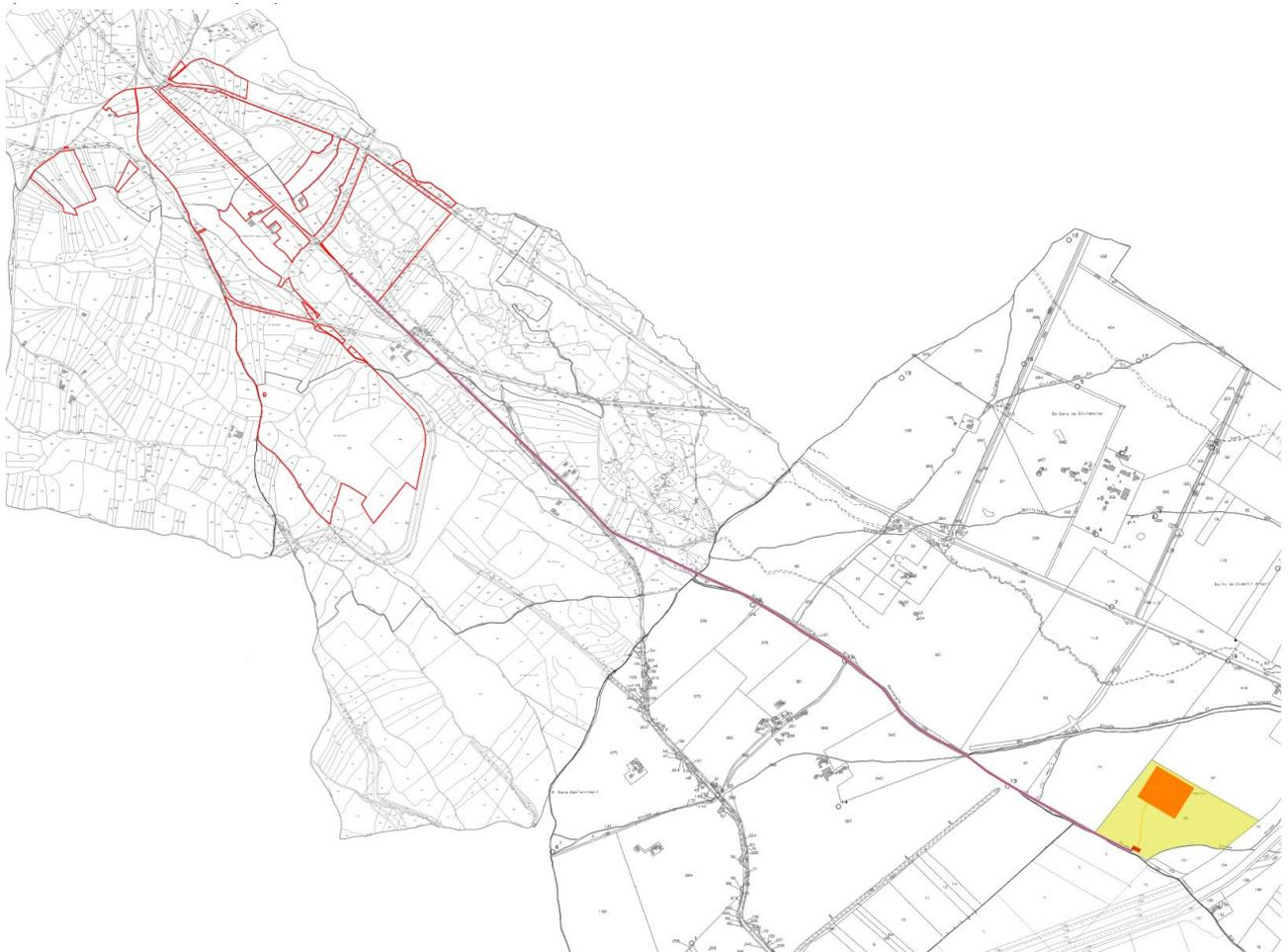
*Figura 16 - Tracciato del cavidotto MT esterno verso la nuova SE*
