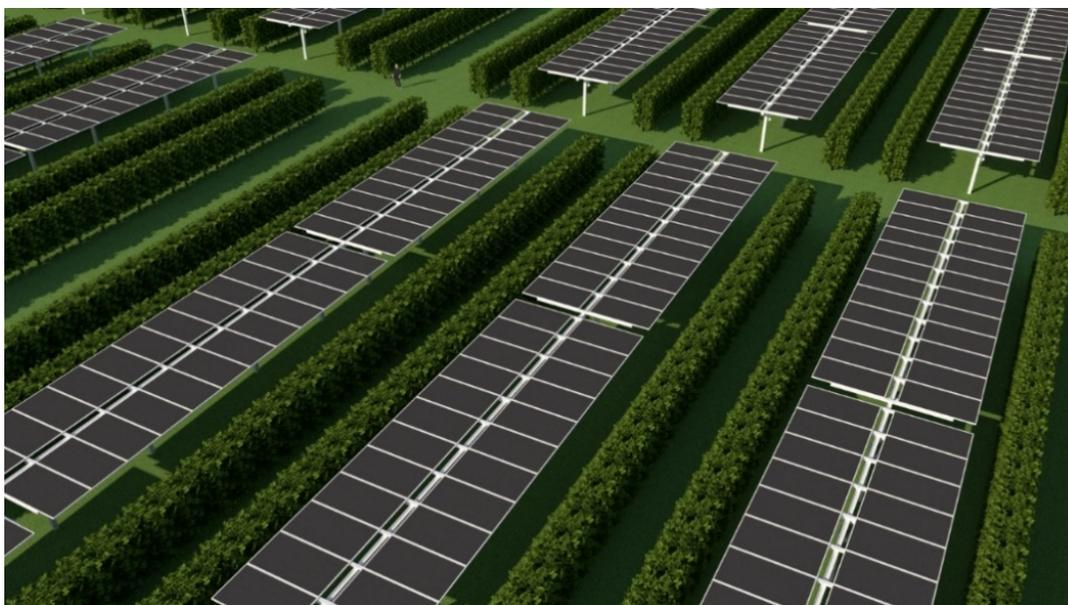
*Figura 86 - Particolare del modello, siepi ulivicole e tracker in posizione orizzontale*
