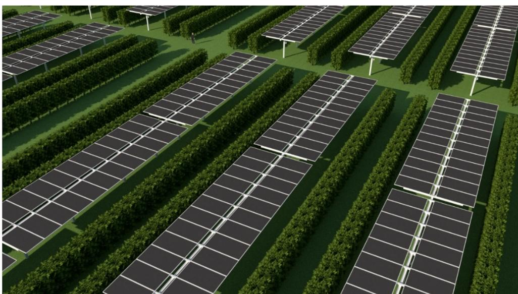
*Figura 7 - Schizzo dell'assetto impiantistico: un filare FV e due siepi ulivicole alternate*
