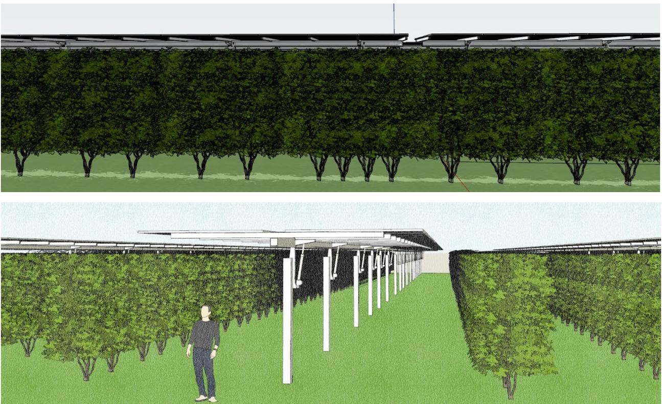
*Figura 95 - Esempio con pannelli orizzontali*
