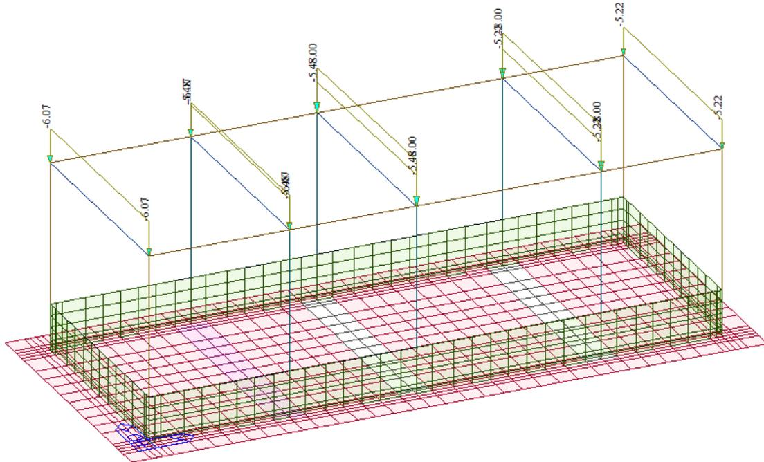
**Figura 16 - G1 – Peso proprio solaio**
