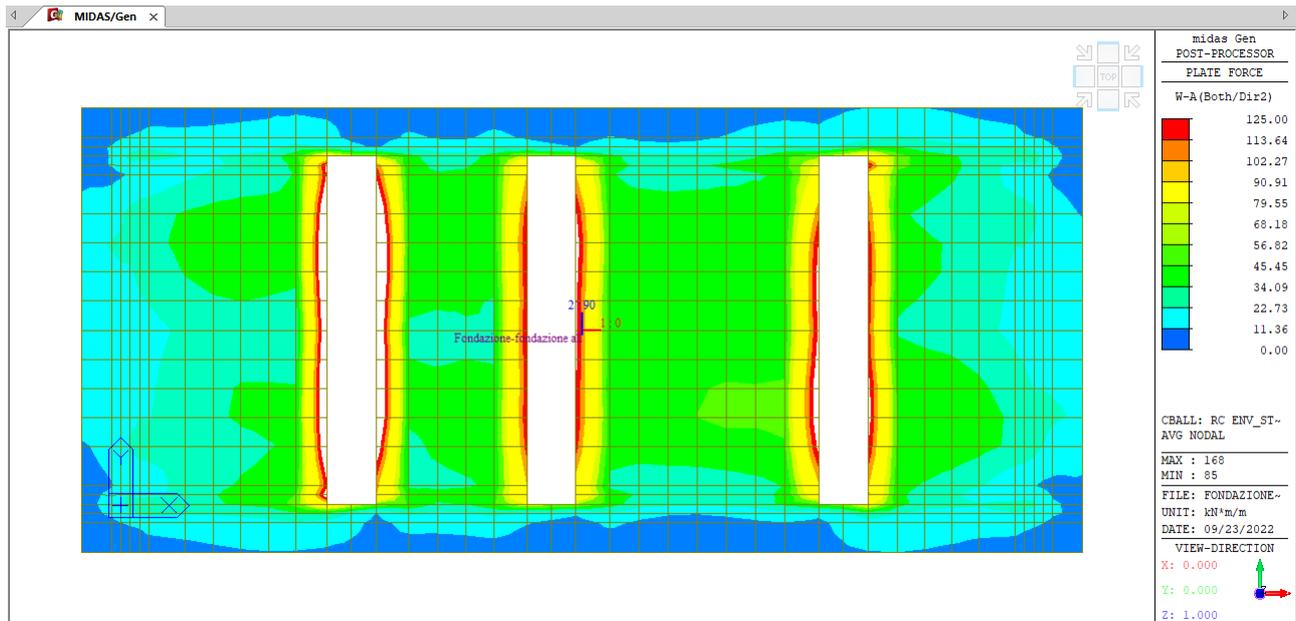
**Figura 32 – Flessione - ENVE – SLR – Armatura minima**
