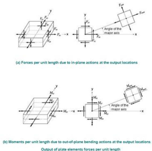
**Figura 29 – Stralcio della guida di Midas Gen per l'esplicitazione della lettura dell'orientamento di forze e momenti.**
