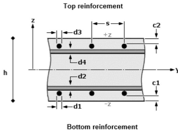
**Figura 30 – Disposizione dell'armatura**
