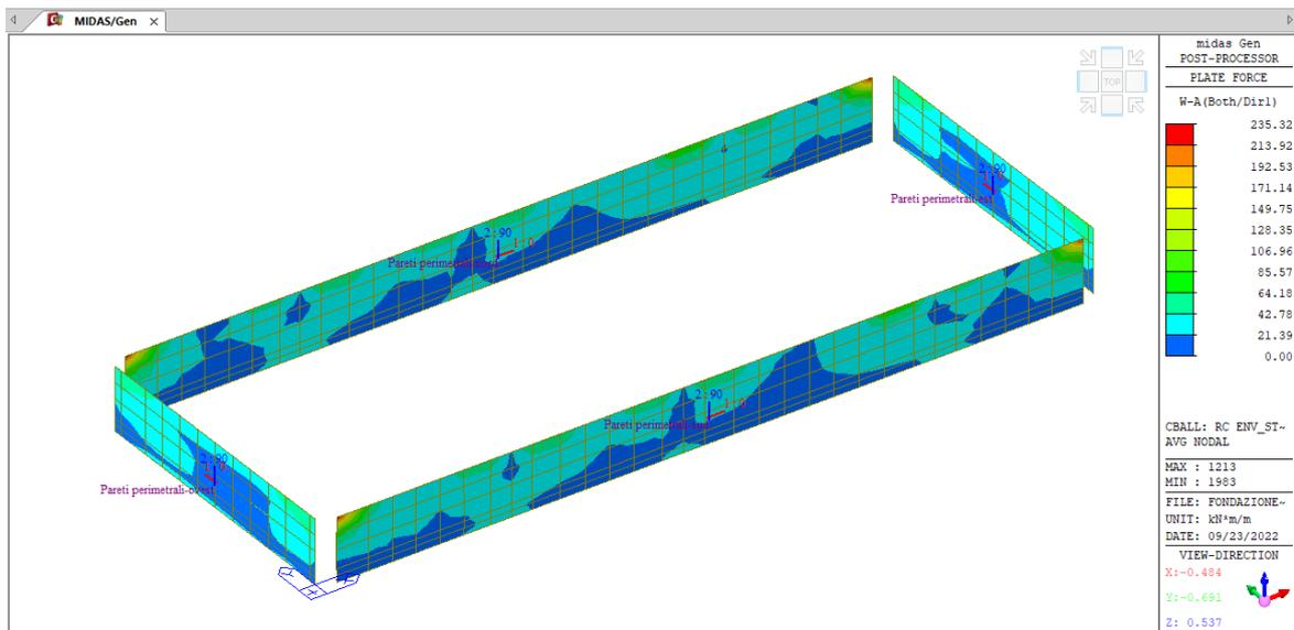
**Figura 48 – Flessione - ENVE – SLR – Armatura minima**
