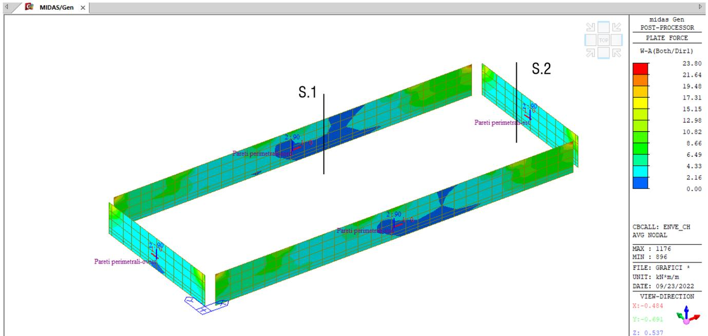
**Figura 50 – Flessione - ENVE – CH – Armatura minima**
