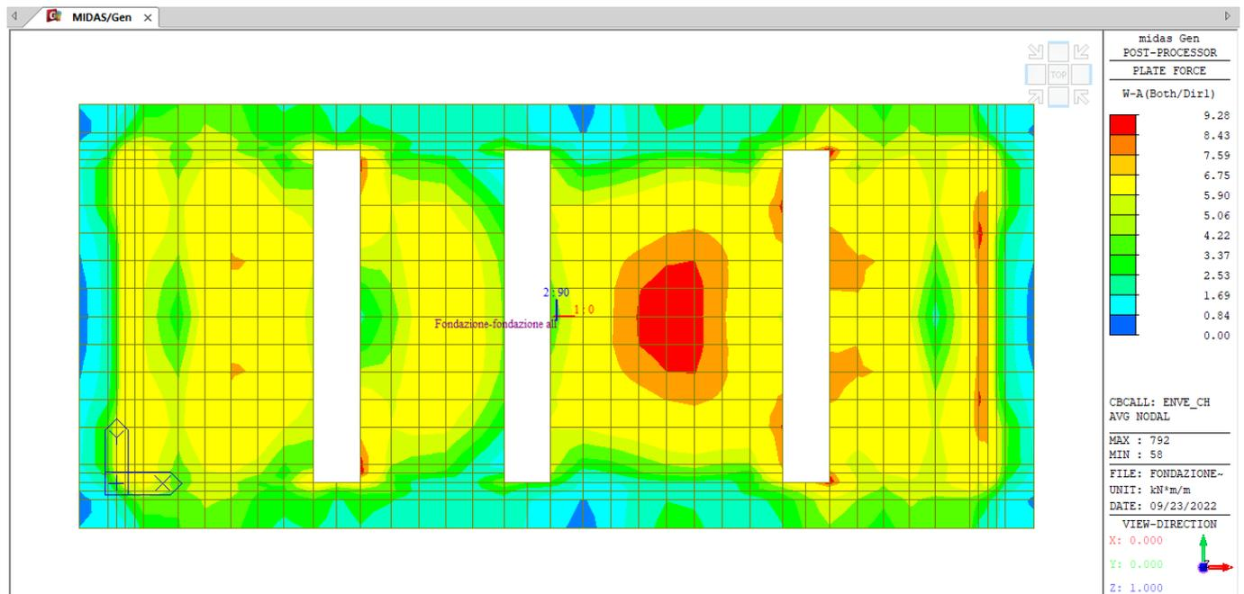
**Figura 37 – Flessione - ENVE – CH – Armatura minima**
