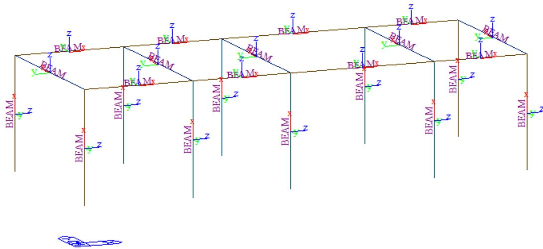
**Figura 14 - Assi locali struttura in elevazione**
