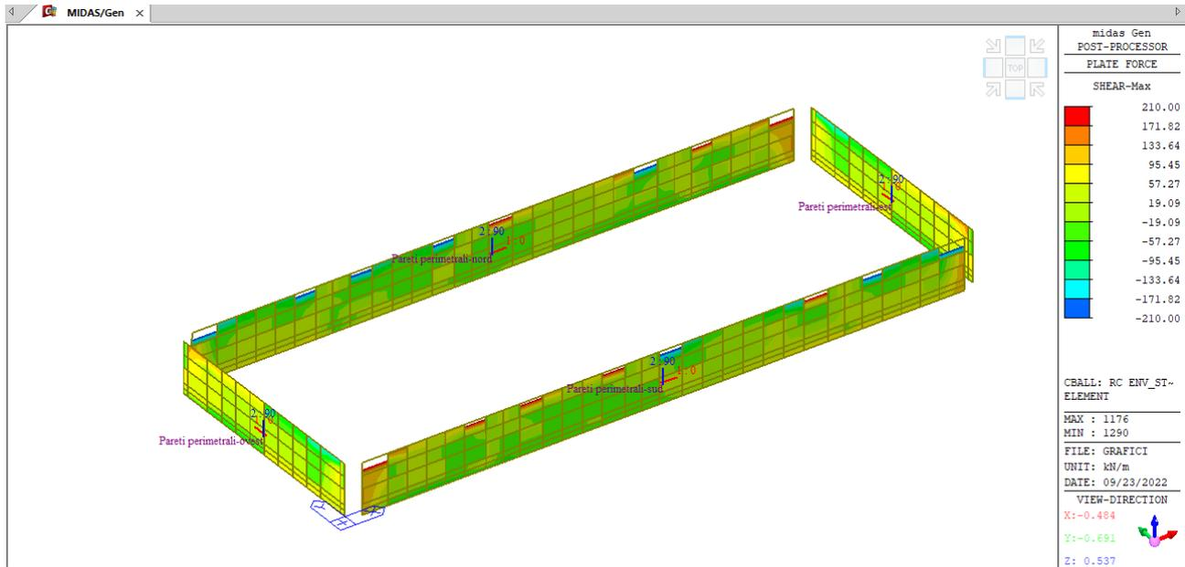
**Figura 51 – Taglio - ENVE – SLR – Armatura minima**
