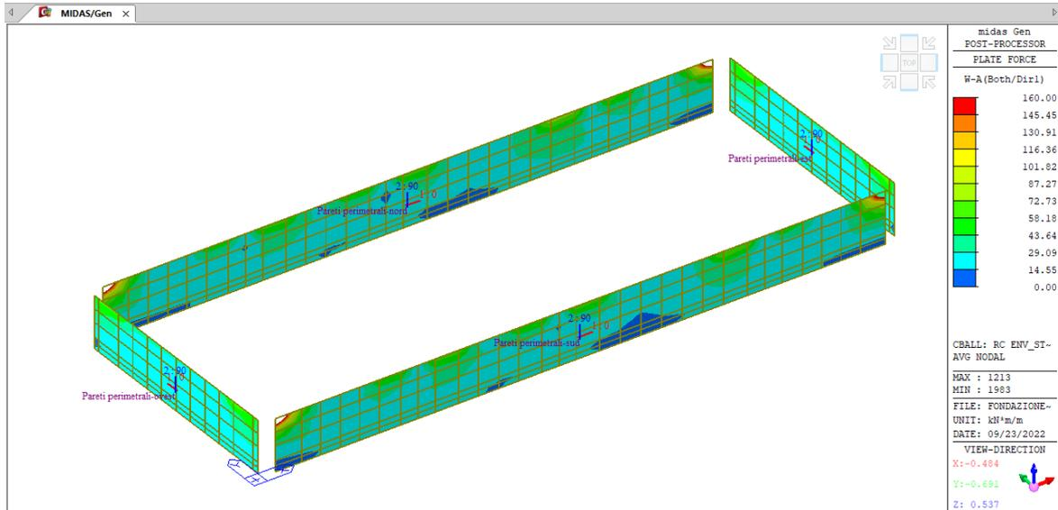
**Figura 47 – Flessione - ENVE – SLR – Armatura minima**
