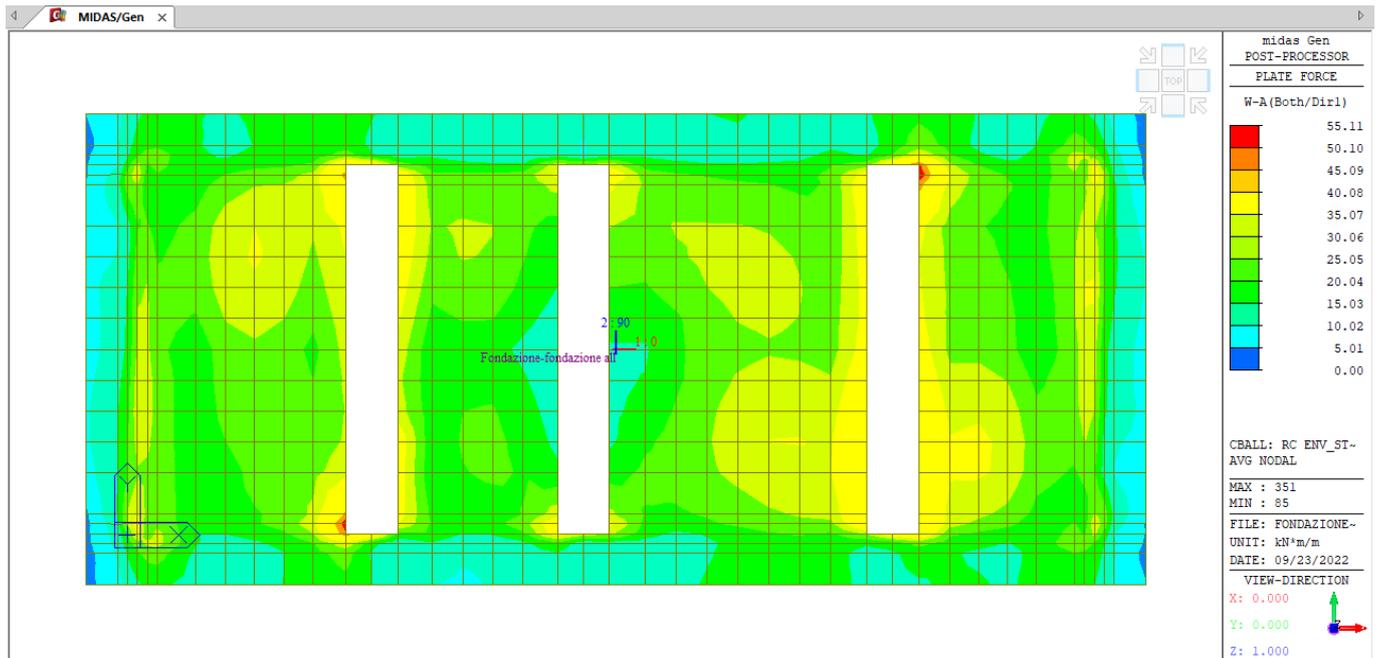
Figura 36 – Flessione - ENVE – SLR – Armatura minima
