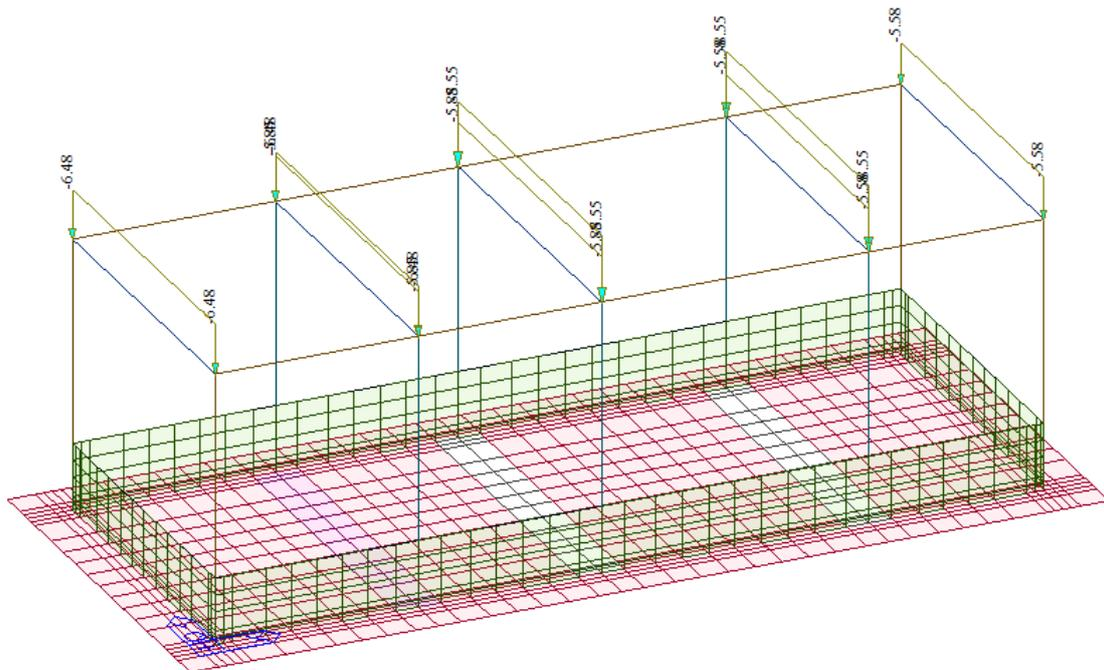
**Figura 17 - G2 – Sovraccarichi permanenti solaio**
