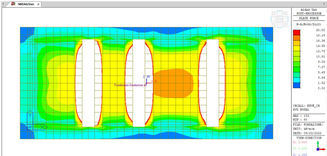
**Figura 34 – Flessione - ENVE – CH – Armatura minima**
