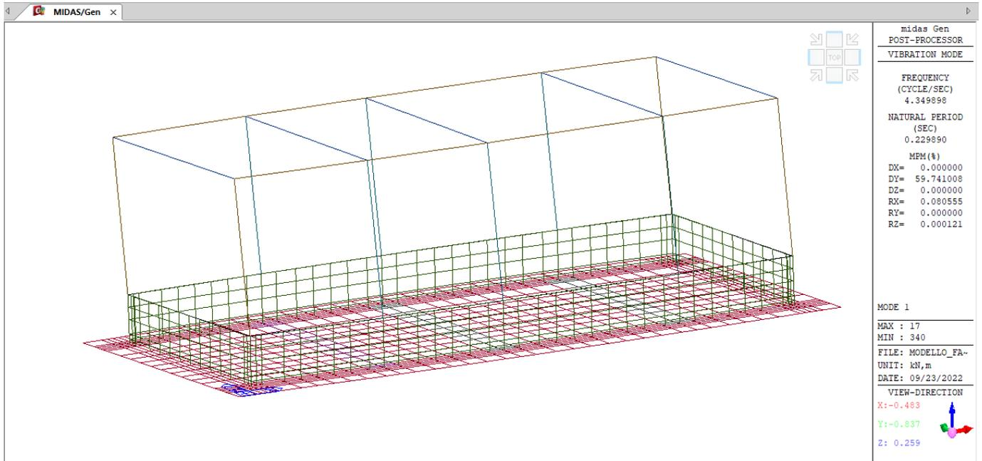
**Figura 26 – Modo 1: diagramma degli spostamenti**
