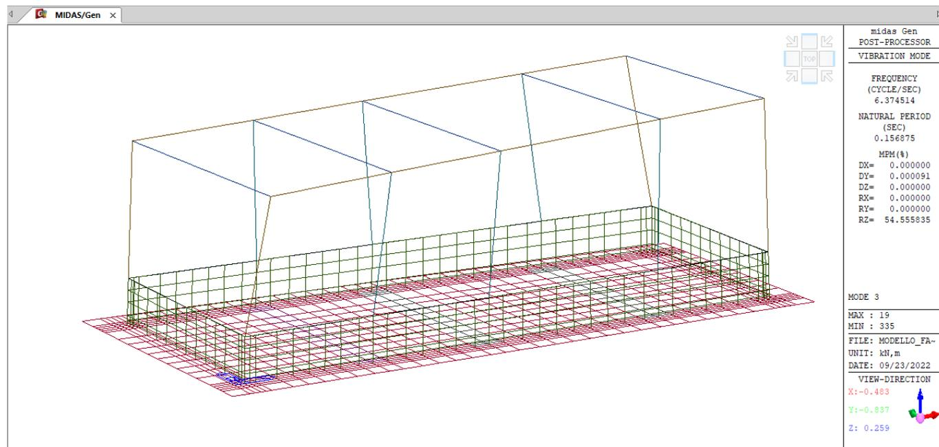
**Figura 28 - Modo 3: diagramma degli spostamenti**
