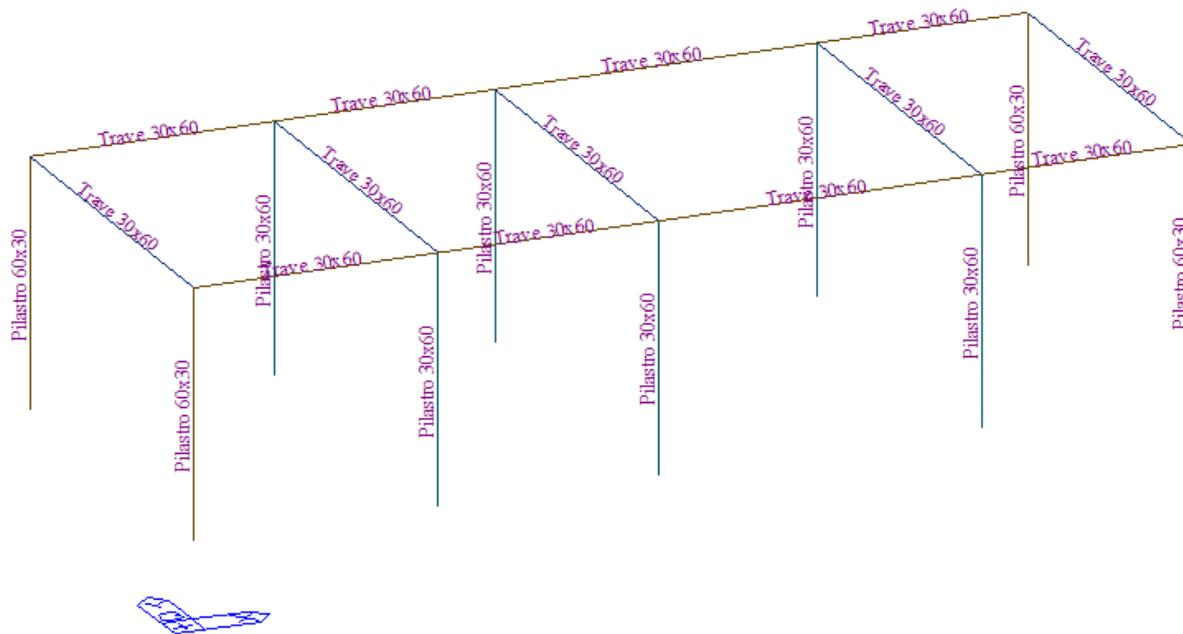
**Figura 15 - Tipologia aste struttura in elevazione**
