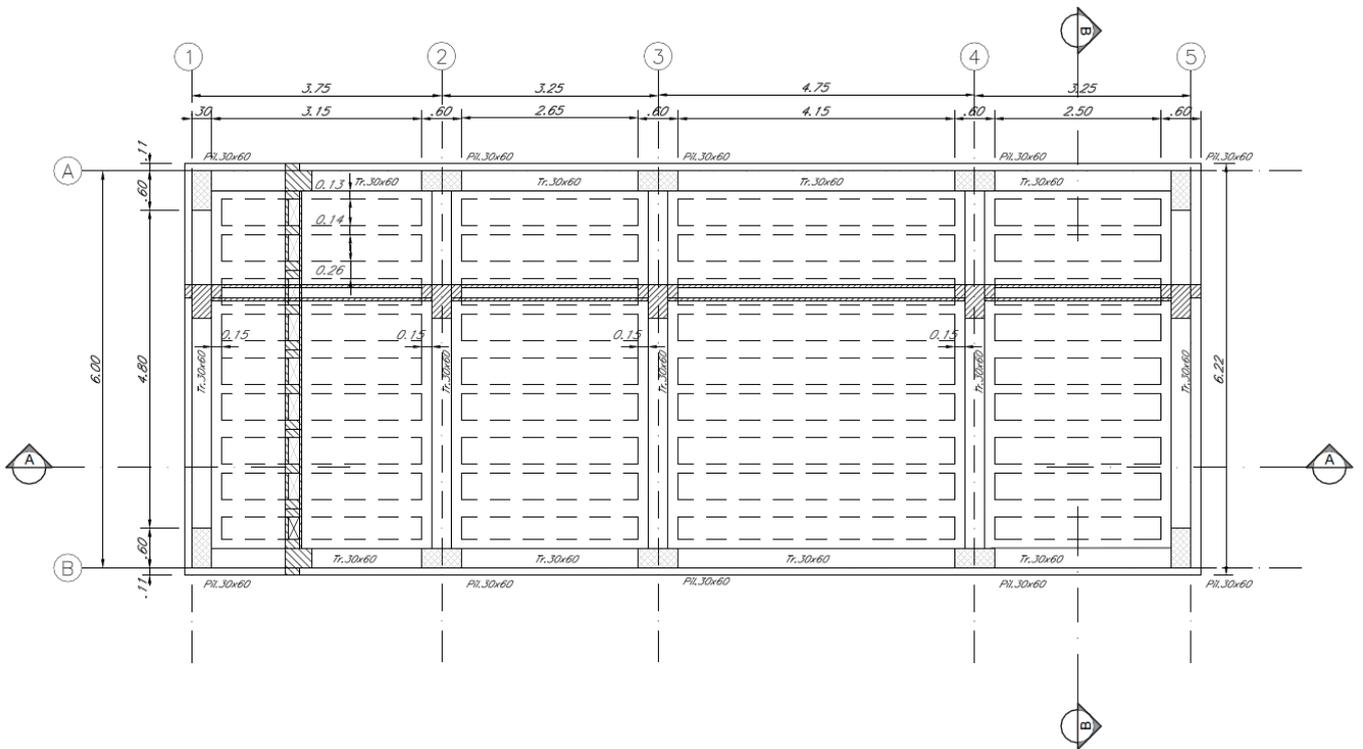
**Figura 2 – Carpenteria copertura**
