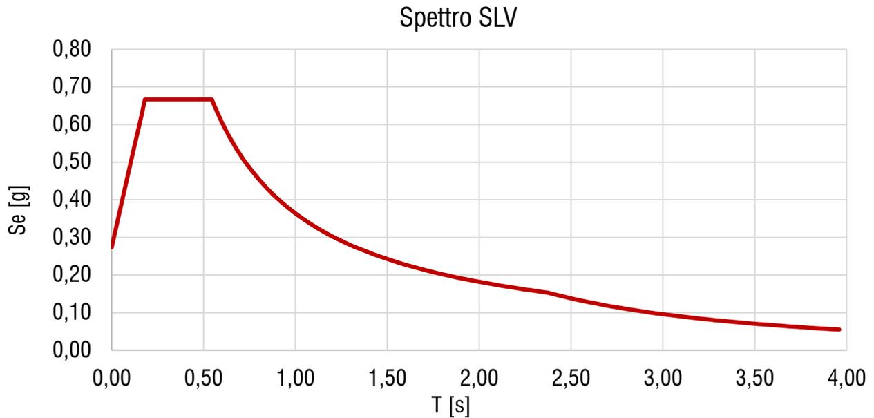
**Figura 9 - Spettro di risposta nella componente orizzontale all'SLV**
