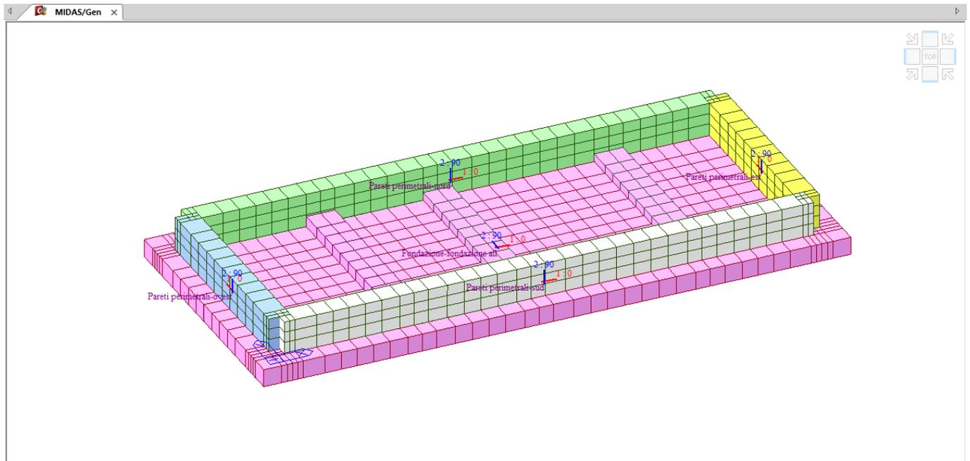
**Figura 43 – identificazione della pareti perimetrali di fondazione**
