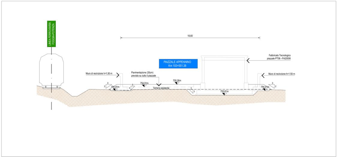
**MURO DI RECINZIONE - SEZIONE SCAVO**
