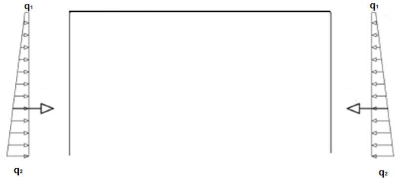
Figura 7-1 - Andamento pressione terreno
