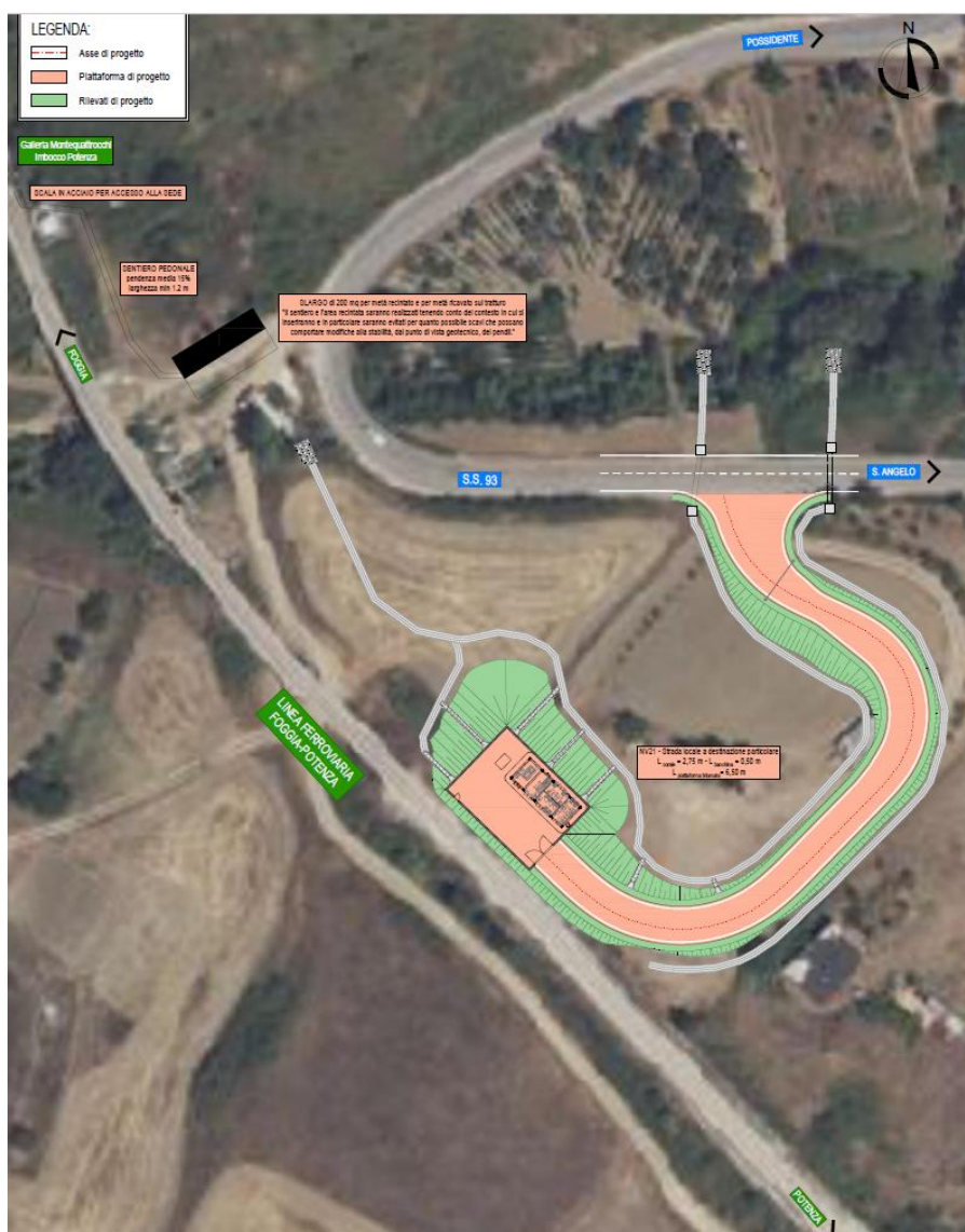
Figura 6 – Imbocco lato Potenza galleria Quattrocchi
