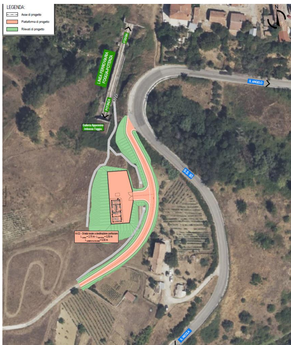
Figura 7 – Imbocco lato Foggia galleria Appennino
