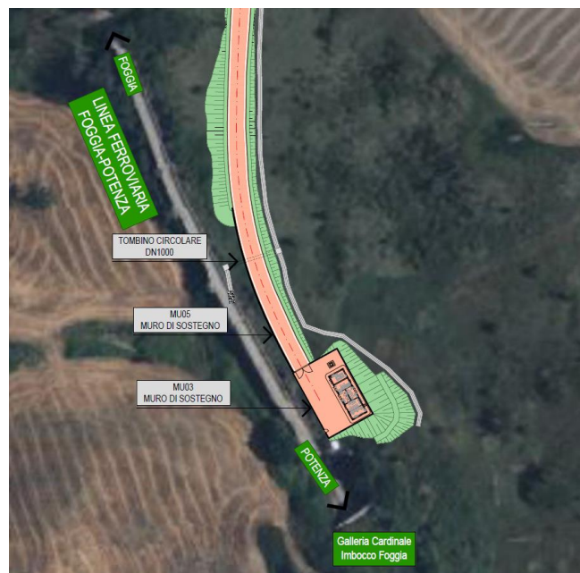
Figura 5-16 – Stralcio viabilità NV19 con posizionamento tombino DN1000
