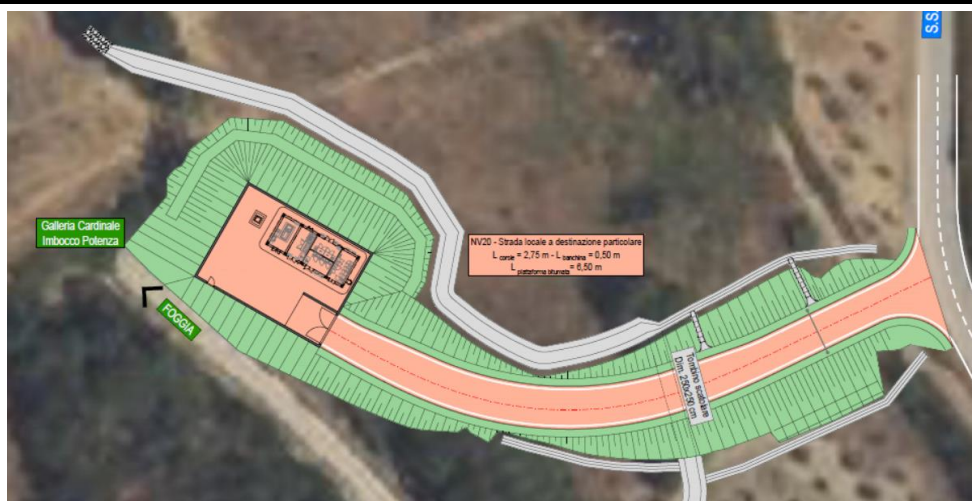
Figura 5-17 – Viabilità NV20 con posizionamento tombino scatolare
