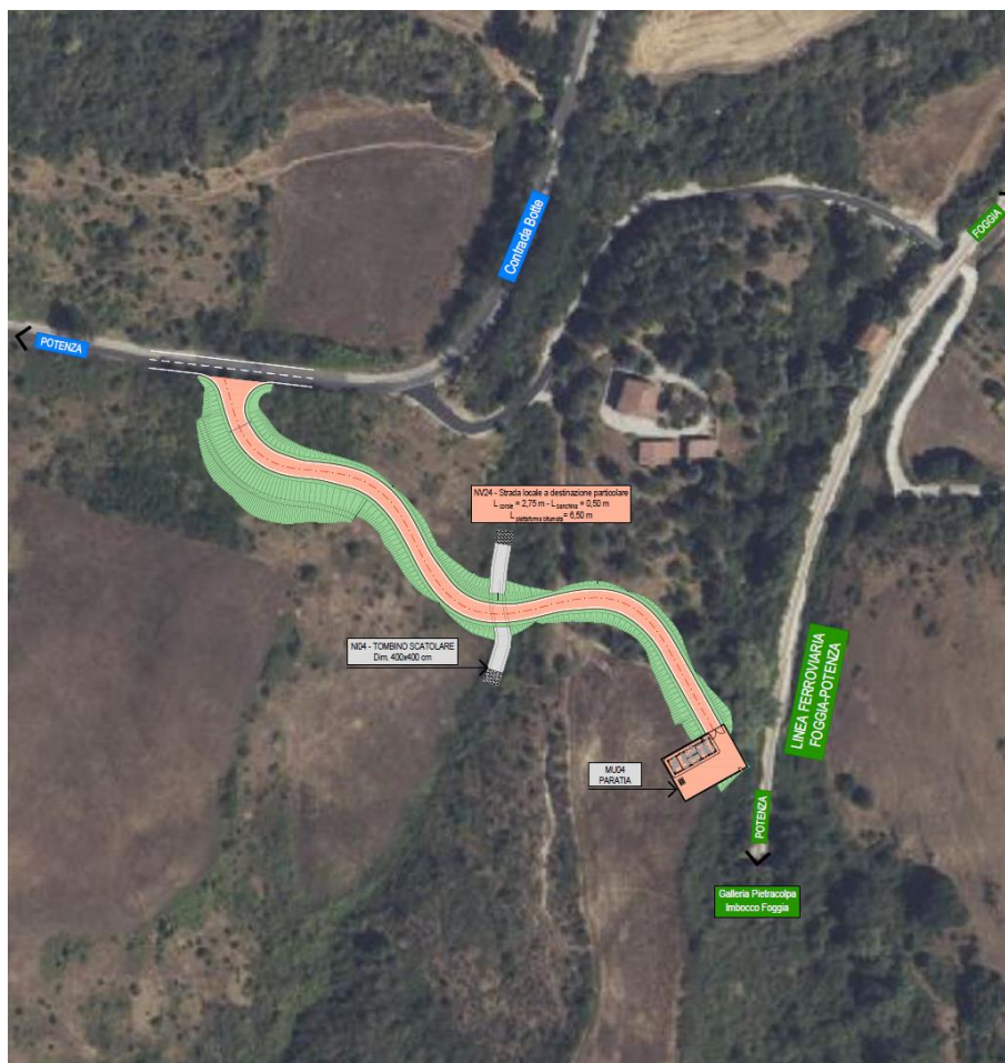
Figura 23 – Soluzione imbocco galleria Pietracolpa lato Foggia
