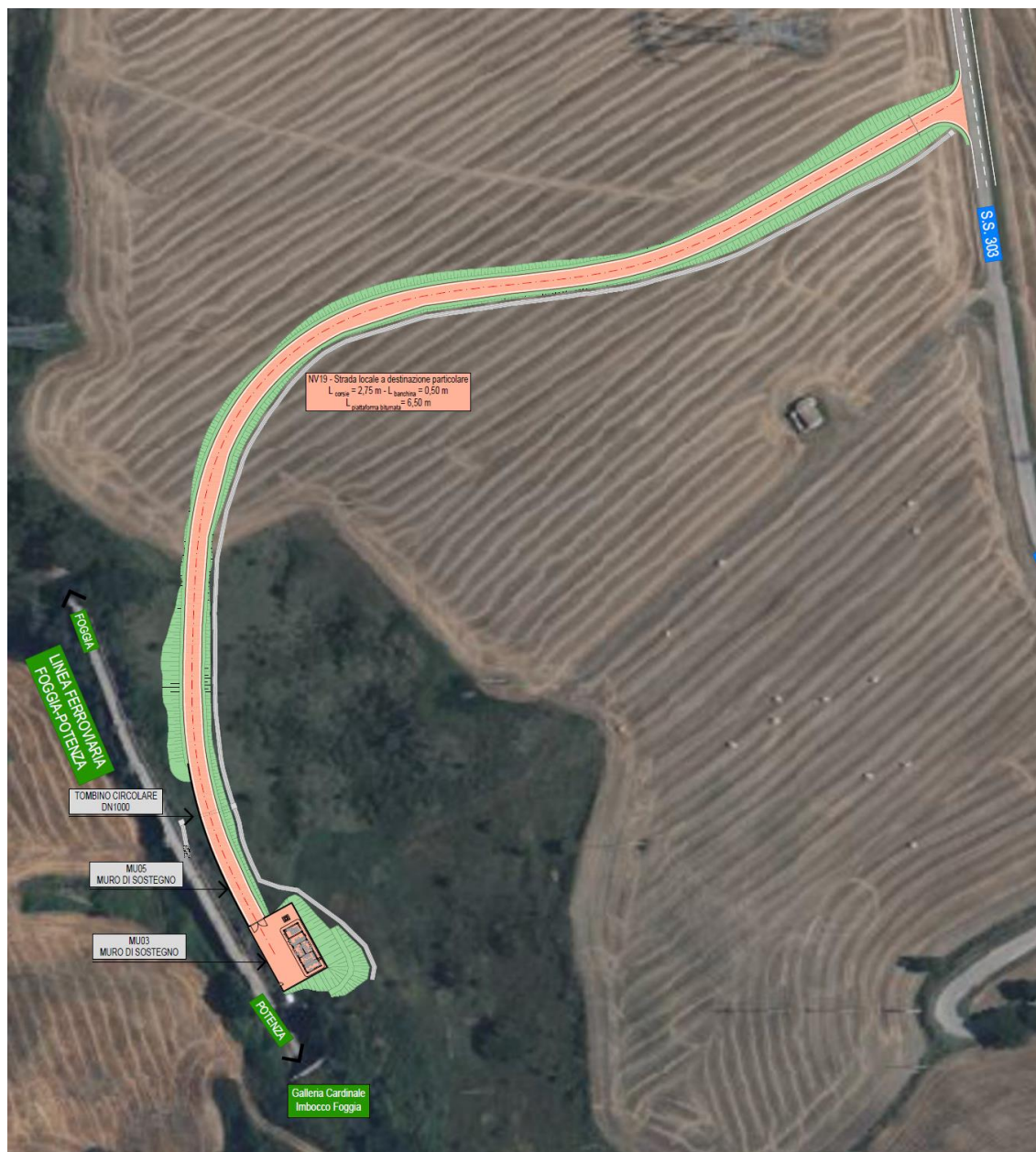
Figura 15 – Soluzione imbocco galleria Cardinale lato Foggia
