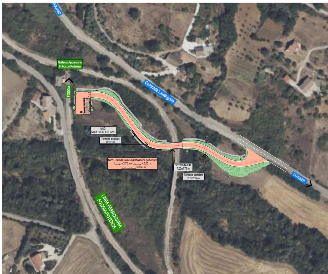
Figura 22 – Soluzione imbocco galleria Appennino lato Potenza
