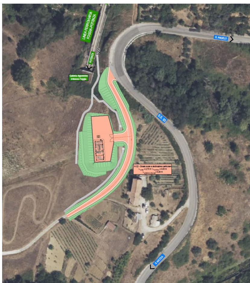
Figura 21 – Soluzione imbocco galleria Appennino lato Foggia
