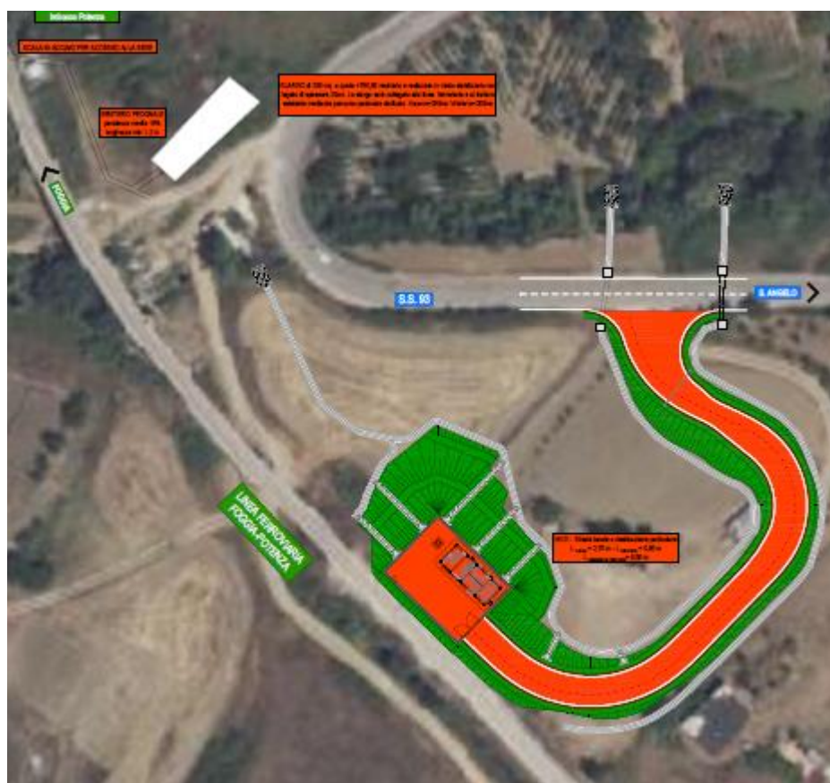
Figura 20 – Soluzione imbocco galleria Monte Quattrocchi lato Potenza
