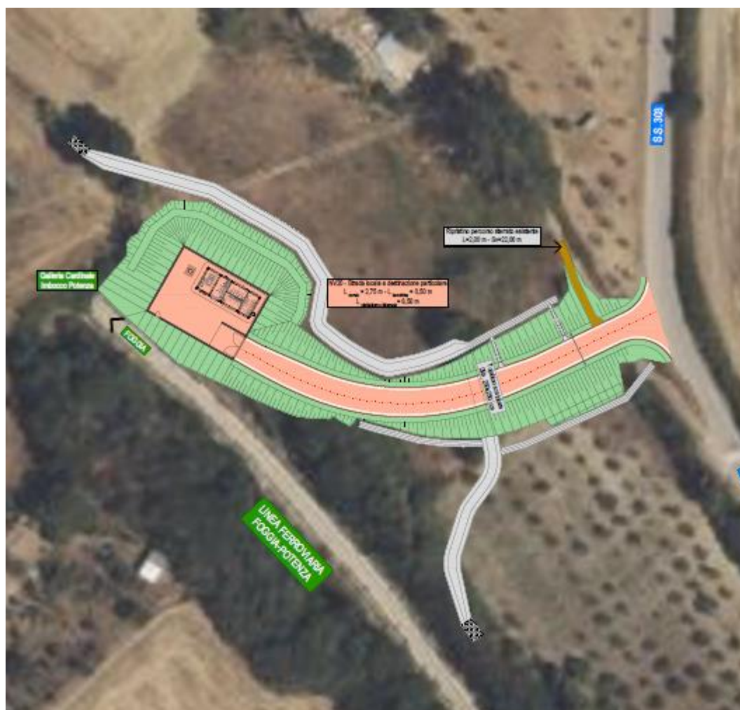
Figura 16 – Soluzione imbocco galleria Cardinale lato Potenza
