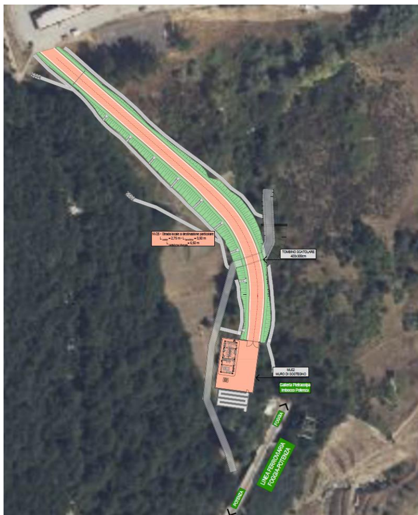
Figura 24 – Soluzione imbocco galleria Pietracolpa lato Potenza
