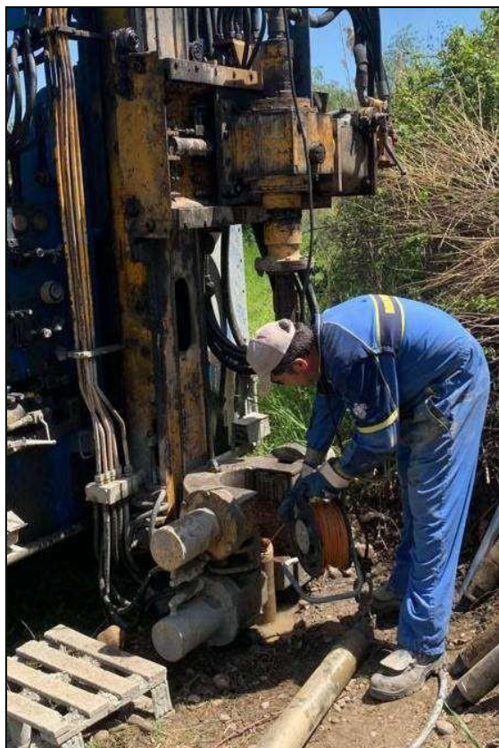
Figura 3 - Esecuzione prova di permeabilità Lefranc a carico variabile.
